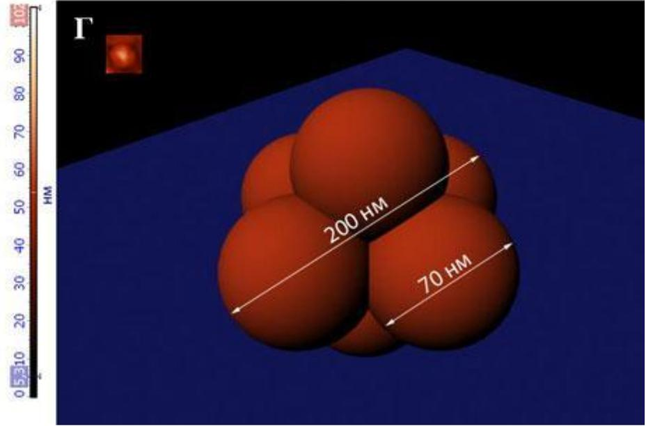
Использование АСМ для определения основных характеристик наночастиц на основе хитозана и галактоманнана.
