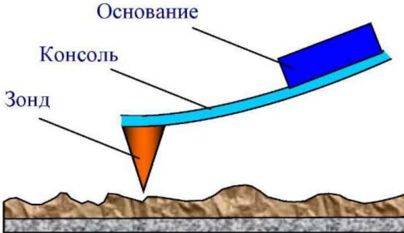
Рис. 1. Схематическое изображение зондового датчика АСМ
