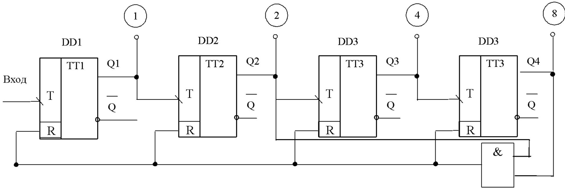
Когда триггеры устанавливаются в состоянии  $1010_2 = 10_{10}$ , на выходе элемента И возникнет импульс, принудительно устанавливающий счётчик в 0, чем исключается его избыточное состояние
