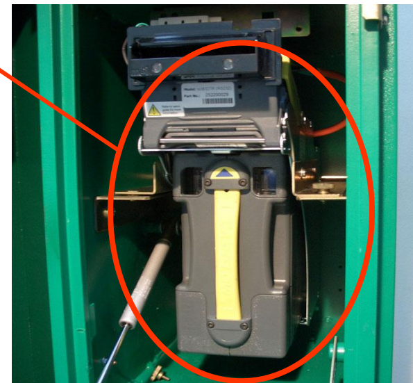
Купюроприемник с кассетой на 1200 банкнот
