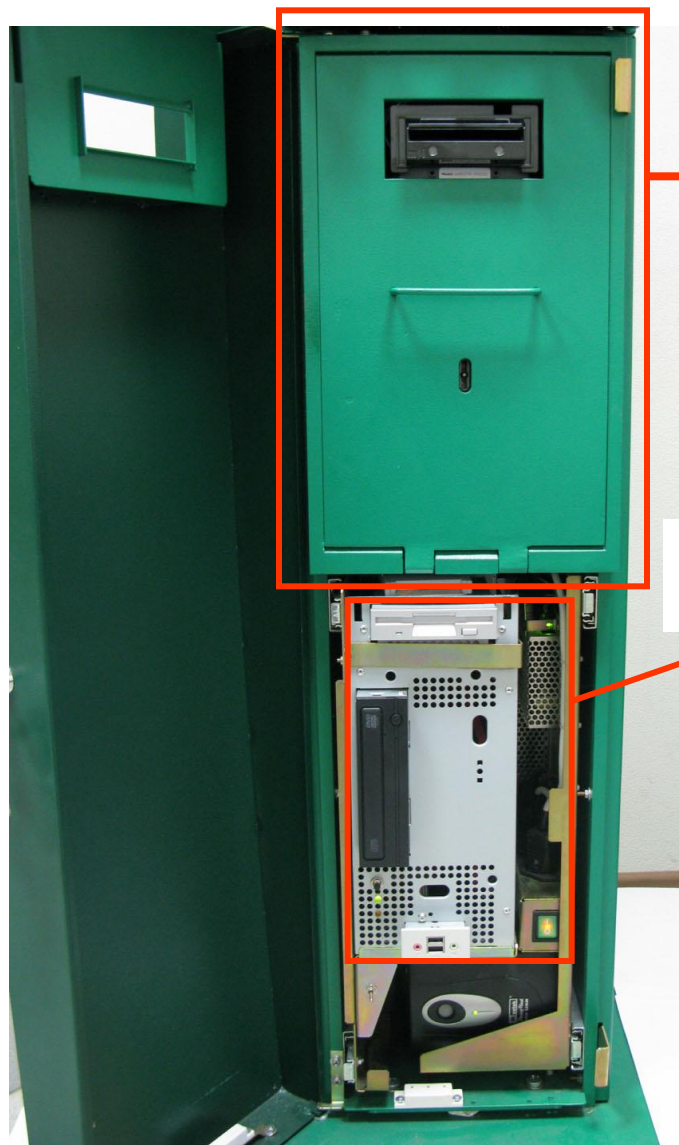
Купюроприемник с кассетой на 1200 банкнот
