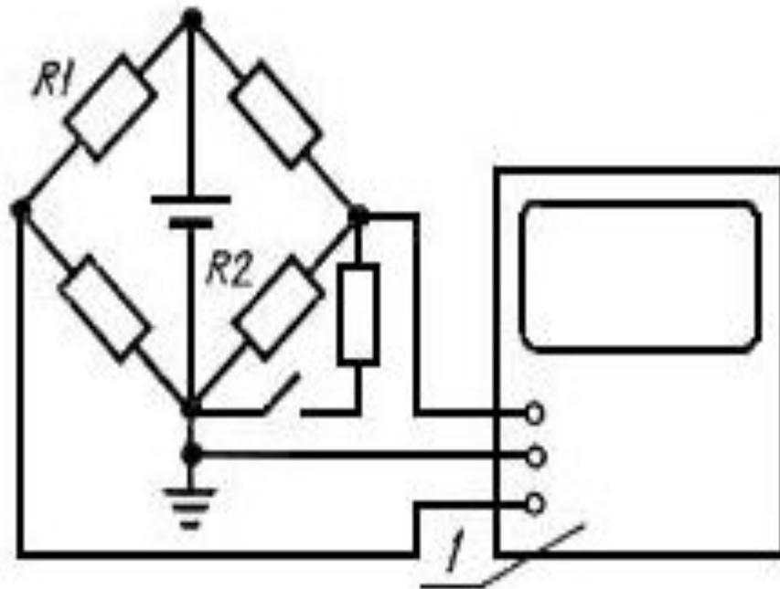
1 - двухканальный электроннолучевой или цифровой осциллограф
