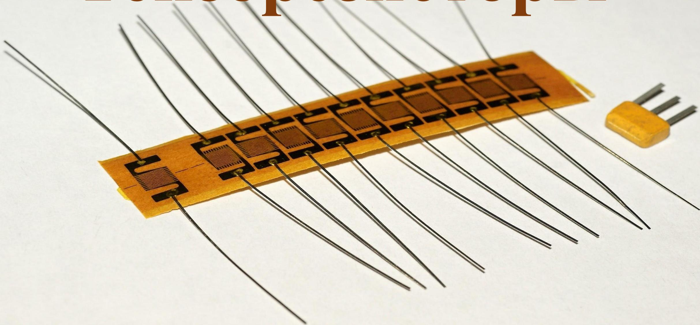
Тензорезистор (от лат. Tensus – напряженный и лат. Resisto – сопротивляюсь) – резистор, сопротивление которого изменяется в зависимости от его деформации.
