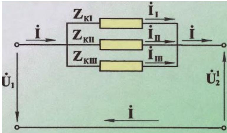
Упрощенная схема параллельной работы трансформаторов
