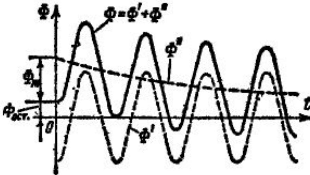
Изменение магнитного потока  $\Phi = f(t)$  [при неблагоприятном моменте включения трансформатора под напряжение]
