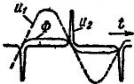
Такая форма вторичного напряжения получается в результате применения весьма сильно насыщающегося сердечника трансформатора, когда магнитный поток на протяжении почти всего полу- периода почти постоянен и резко изменяется только при перемене своего направления.
