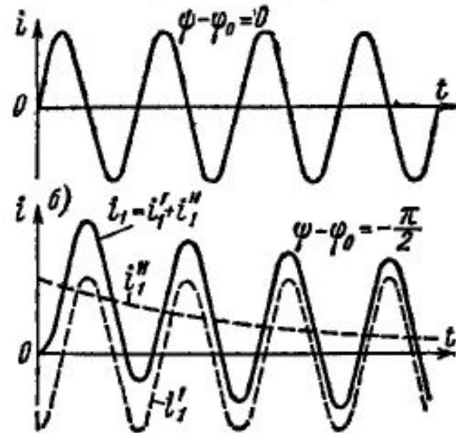
**Ненасыщенный трансформатор  $i_{1\max} = 2I_{1m}$  – удвоенная амплитуда тока холостого хода**
