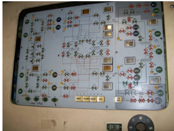
Мнемоническая схема систем жизнеобеспечения станции "МИР"
