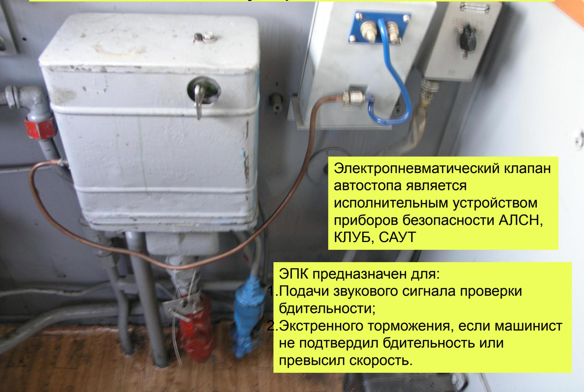
Электропневматический клапан автостопа является исполнительным устройством приборов безопасности АЛСН, КЛУБ, САУТ
