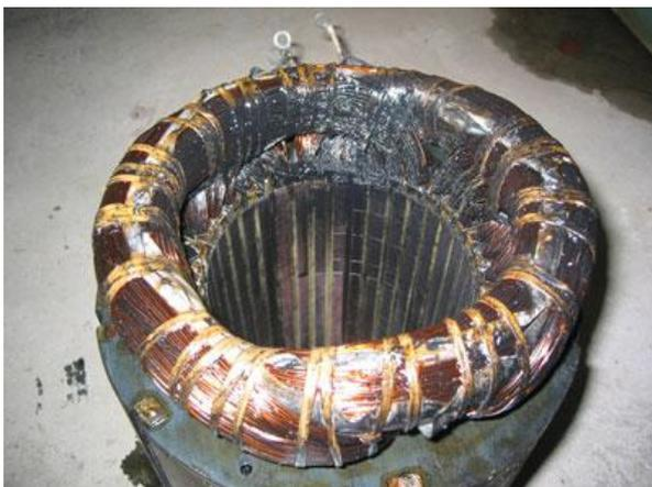
Результат перегрузки электродвигателя при
