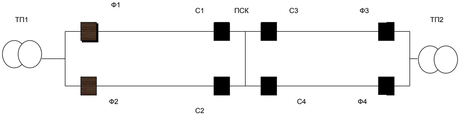
В середине МПЗ включён пост секционирования (ПСК) для электрического соединения КС обеих путей, разделения на секции и защиты КС;
