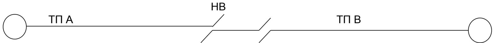
Провода контактной сети межподстанционной зоны (МПЗ) в середине участка между подстанциями разделяются, как правило, нейтральной вставкой на две секции на посту секционирования (ПСК). Питание каждой секции осуществляется от одной подстанции. Разделение секций нейтральной вставкой вызвано возможной значительной разницей напряжения, появлением дуги при замыкании токоприёмником двух секций КС и её пережога.
