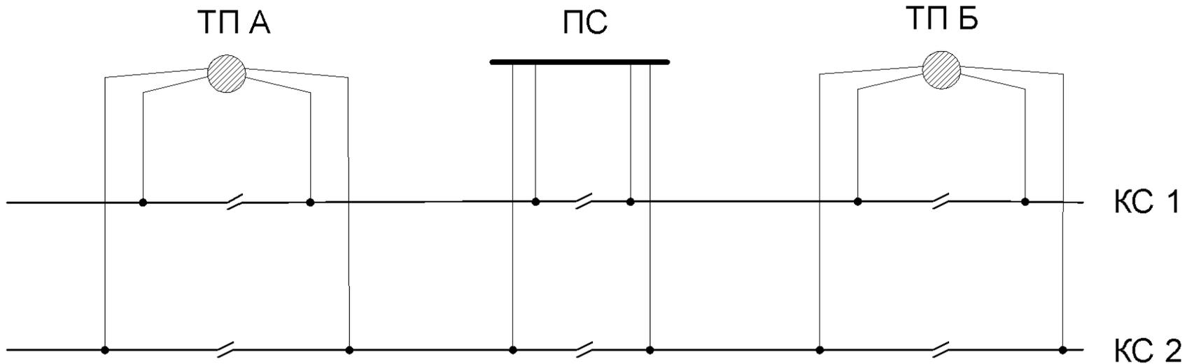
При узловой схеме между контактными подвесками появляется одна общая точка (обычно в середине межподстанционной зоны).
