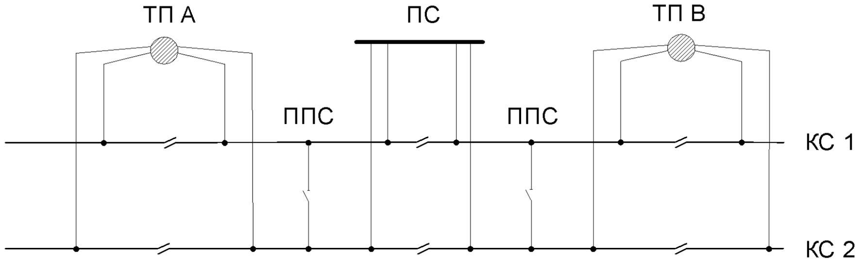
При параллельной схеме питания между контактными подвесками смежных путей 3 и более общих точек (обычно это делается с помощью пунктов параллельного соединения- ППС).
