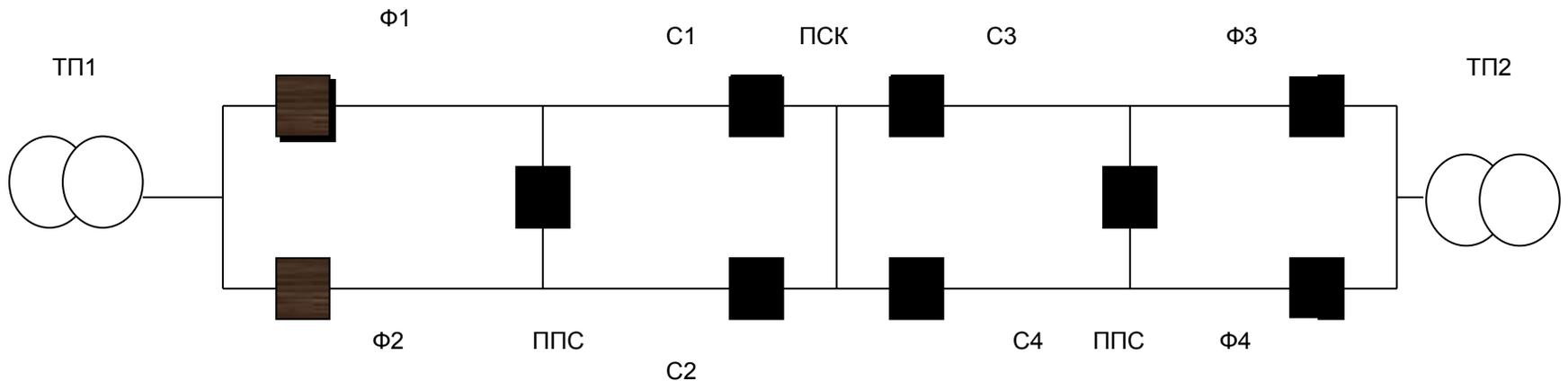
Между ПСК и ТП включены дополнительно пост параллельного соединения (ППС), который электрически соединяет КС обеих путей
