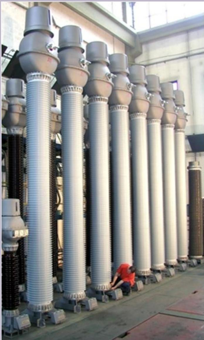
Чрезвычайно высокие стоимостные и массогабаритные параметры измерительных трансформаторов тока высокого напряжения ограничивают их широкое применение из-за необходимости сооружения изолирующих конструкций.
