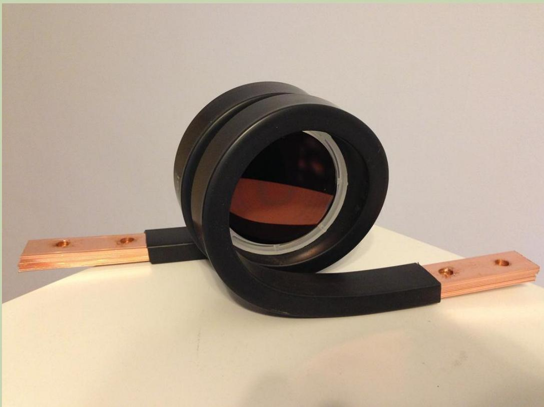
Магнитооптическая пленка сенсорного блока расположена в шине колец Гельмгольца, обеспечивающих равномерное распределение магнитного поля по поверхности сенсорной пленки
