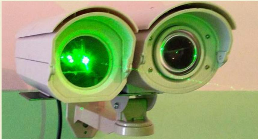
Конструкция лазерного измерителя тока состоит из сенсорного блока, блока лазерного модулятора и приемно-аналитического блока.
