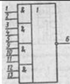
Мікросхема K533LP13 елемент (2-3-3-2)І- 4АБО-НЕ
