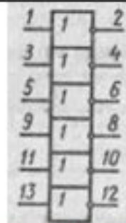
Мікросхема K530LN2 6 елементів НЕ
