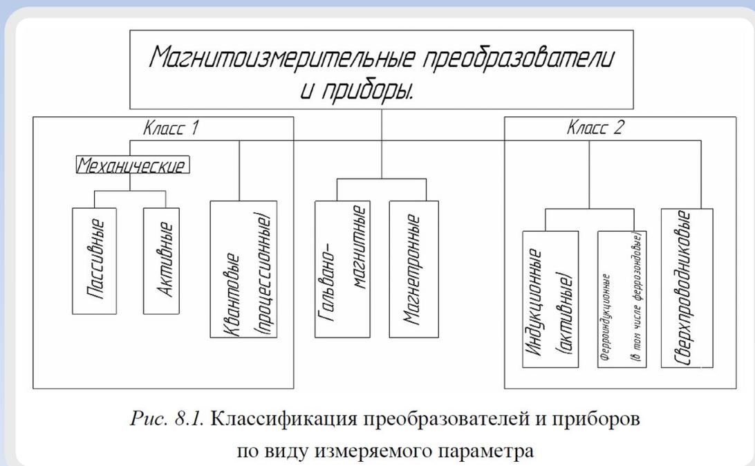
Рис. 8.1. Классификация преобразователей и приборов по виду измеряемого параметра
