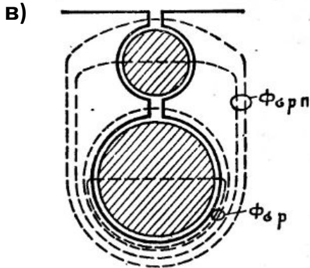
**Рис. 17. Двухклеточный ротор:**
