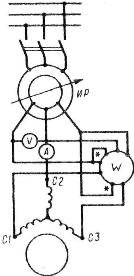
**Рис.8 Схема включения трехфазного асинхронного двигателя при опытах х.х. и к.з.**
