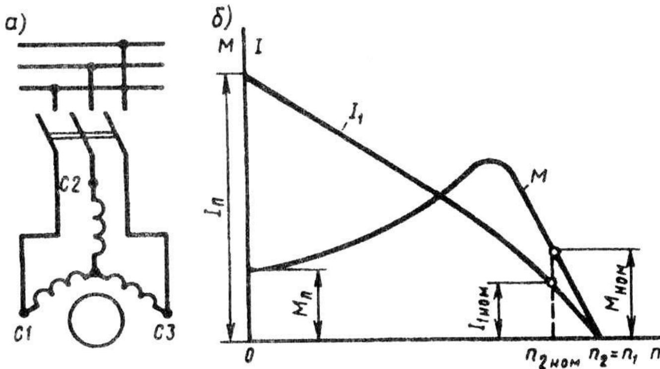
**Рис.12.Схема непосредственного включения в сеть (а) и графики изменения тока и момента при пуске (б) АД с короткозамкнутым ротором**
