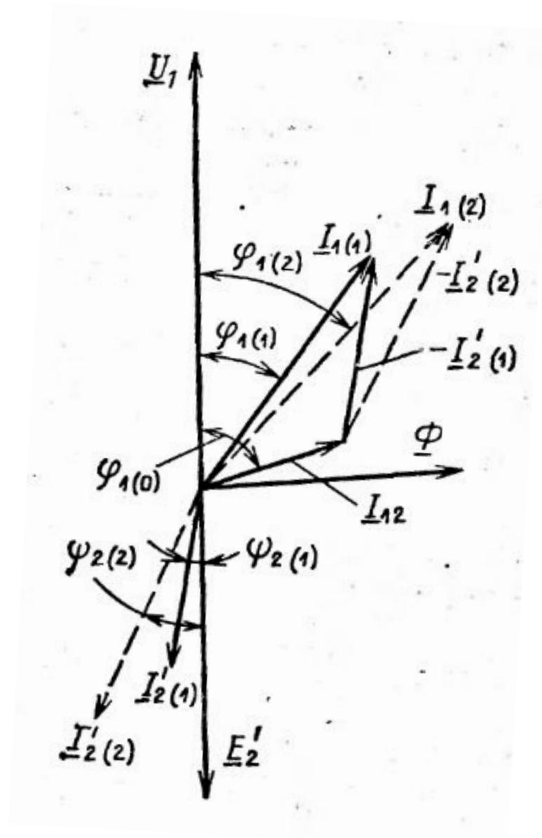
Рис. 3 Влияние нагрузки двигателя на  $\cos \varphi_1$
