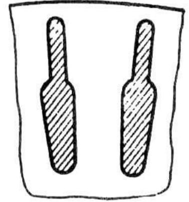
**Рис. 16** Бутылочная форма стержней ротора
