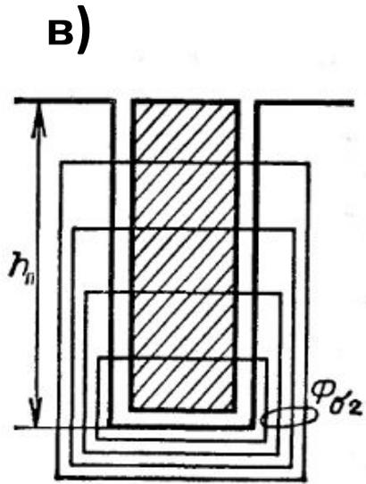
На рис. 15, б «пуск» показан график распределения плотности пускового тока в стержне ротора. Из графика следует, что почти весь ток ротора проходит по верхней части стержня, поперечное сечение которой намного меньше сечения всего стержня. Это равноценно увеличению активного сопротивления ротора, что, как известно, способствует росту  $M_{\Pi}$  двигателя и некоторому ограничению  $I_{\Pi}$  (см. (1) и (2)).
