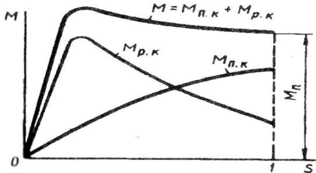
Рис. 18. Механическая характеристика двухклеточного асинхронного двигателя
