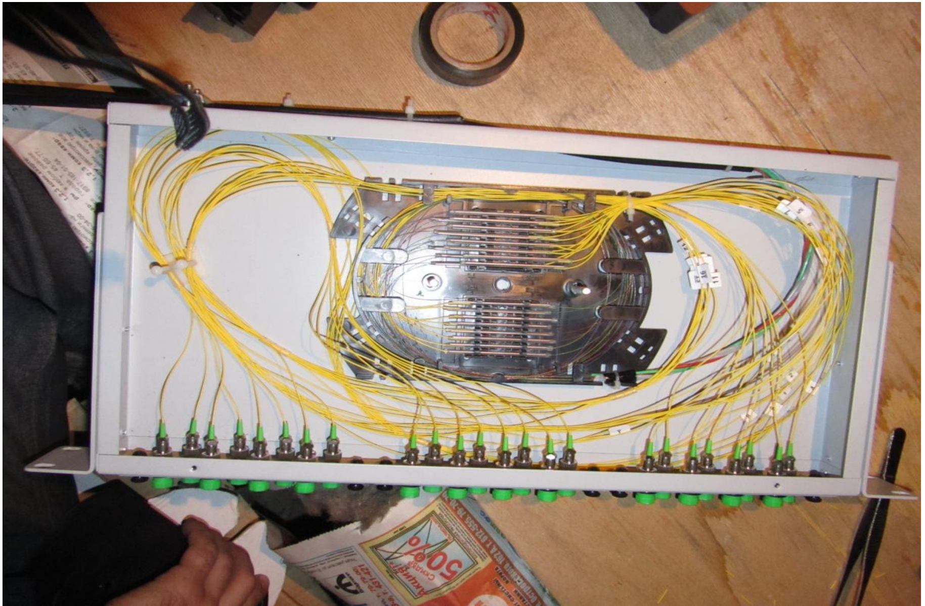
Сваренный кросс на 24 порта типа FC/APC, одноюнитовый
