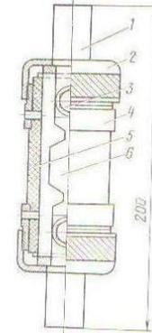
Предохранитель типа ПР2:
