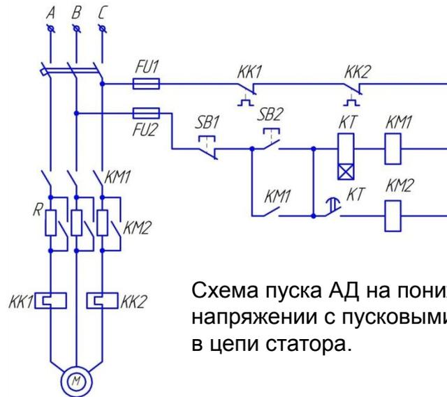
Схема пуска АД на пониженном напряжении с пусковыми резисторами в цепи статора.
