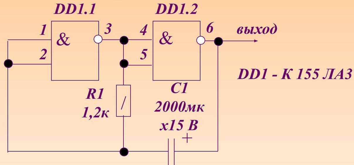
На элементах DD1.1 и DD1.2 собран генератор, вырабатывающий прямоугольные импульсы, которые следуют со сравнительно малой частотой - она зависит от ёмкости конденсатора C1 и сопротивления резистора R1. Импульсы мультивибратора снимаются с выхода 6 элемента DD1.2.
