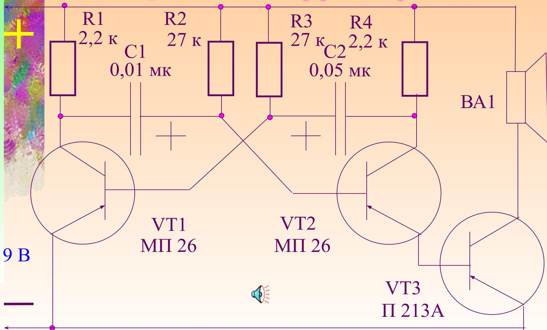
*Такой мультивибратор используется для звуковой индикации в таблицах умножения - деления и сложения - вычитания.*
