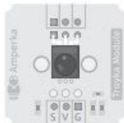
Тройка-модуль ИК-приёмник Принимает команды ИК-пульта
