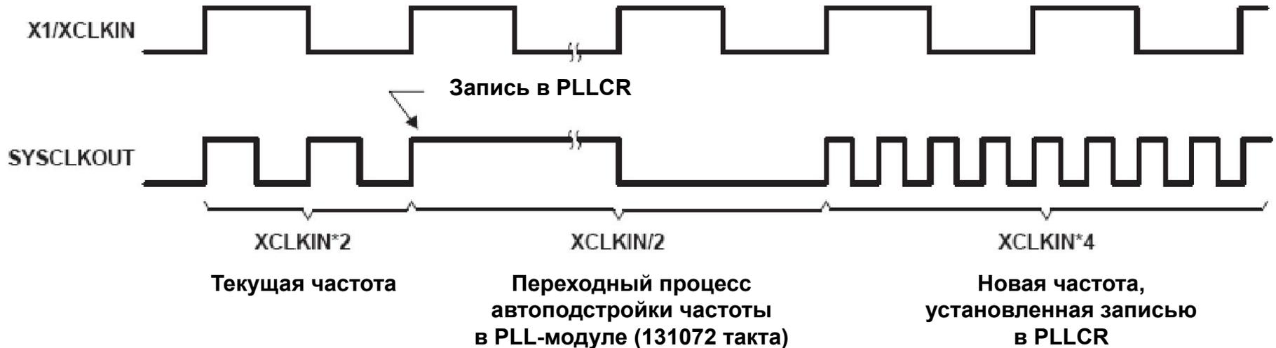
Время переключения на новую частоту составляет 131072 периодов входной тактовой частоты (в течение этого времени устанавливается системная частота  $f_{SYSCLKOUT} = f_{CLKIN}/2$ ), поэтому в программах иногда после записи в регистр PLLCR, необходимо вставлять программную временную задержку.
