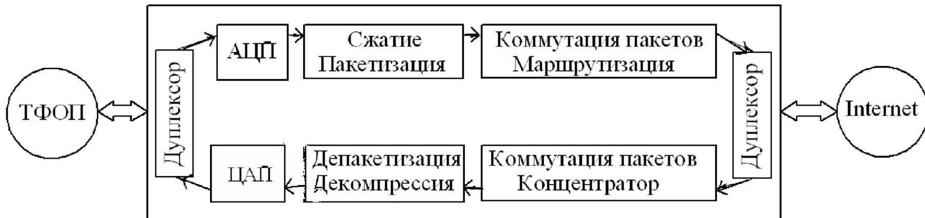
*Телефонный шлюз (IP-шлюз, ITG-IT Gateway) преобразует аналоговые речевые и служебные сигналы в цифровую последовательность, организует из этой последовательности пакеты глобальной сети Internet и передает их в сеть. Кроме того, он принимает пакеты и восстанавливает цифровую последовательность из цифровых речевых и служебных сигналов, а также преобразует их в аналоговую форму.*
