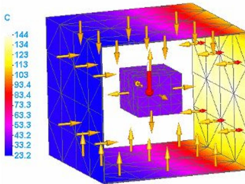
К упрощенной модели печи применены следующие нагрузки. Боковины удалены, чтобы лучше видеть внутреннюю область.
