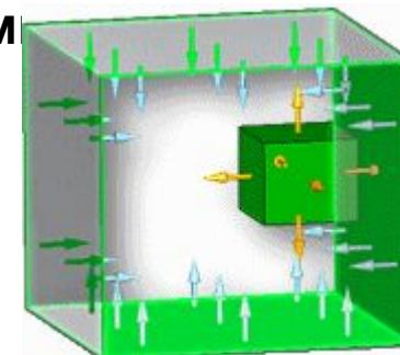
Для четырех внутренних стенок установлен параметр **Экранироваться другими поверхностями**.
