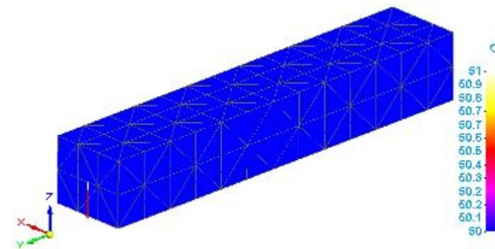
Чтобы показать разницу температур в детали, можно применить вторую нагрузку **Температура** как тепловое ограничение, задав другое значение температуры для противоположного элемента.
