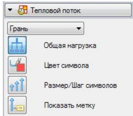
Команда нагрузки **Тепловой поток** позволяет рассчитать тепловую энергию, передаваемую через единицу площади (поверхность, кривую, ребро, узел или точку) и определяет нагрузку тепловой мощности, тепловыделения или теплообмена.
