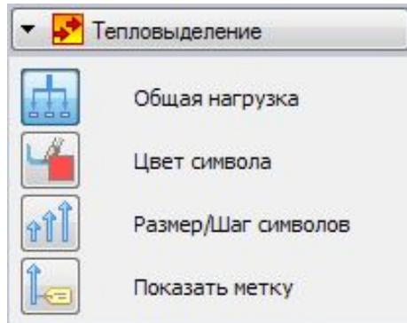
Команда нагрузки **Тепловыделение** позволяет определить нагрузку тепловой мощности, тепловыделения или теплообмена для всего тела. Эта нагрузка задает скорость, с которой тепловая энергия передается через единицу объема (тело или компонент). Обычно это тепло должно проводиться до границ тела и удаляться путем конвекции или излучения.
