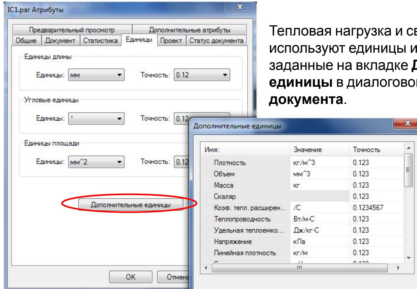
Тепловая нагрузка и свойства материала используют единицы измерения, заданные на вкладке **Дополнительные единицы** в диалоговом окне **Атрибуты документа**.
