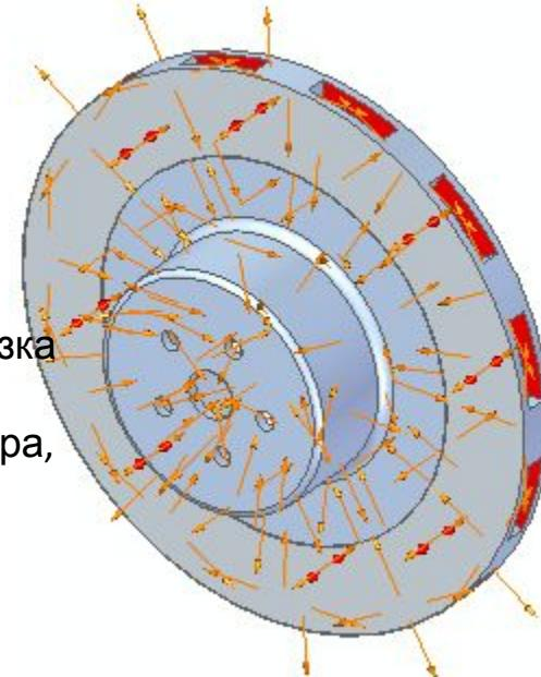
Для расчета рассеяния тепла применяется нагрузка **Конвекция** ко всем поверхностям диска ротора, кроме поверхностей с заданной нагрузкой **Тепловой поток**.
