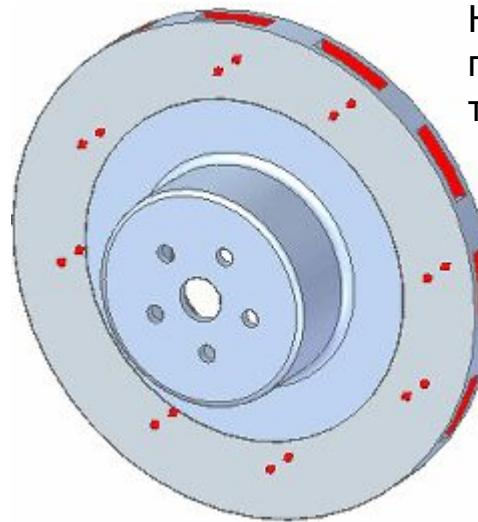
Нагрузка **Тепловой поток** применяется к поверхностям тормозного диска ротора.
