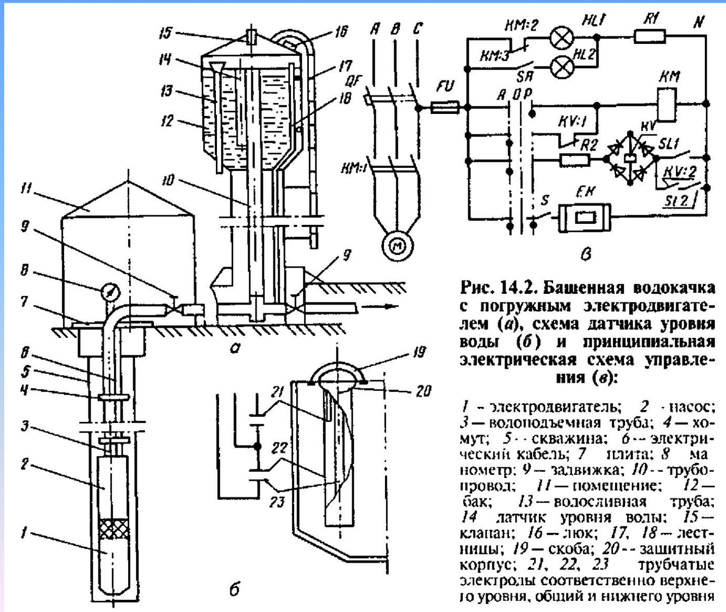
Рис. 14.2. Башенная водокачка с погружным электродвигателем (а), схема датчика уровня воды (б) и принципиальная электрическая схема управления (в):
