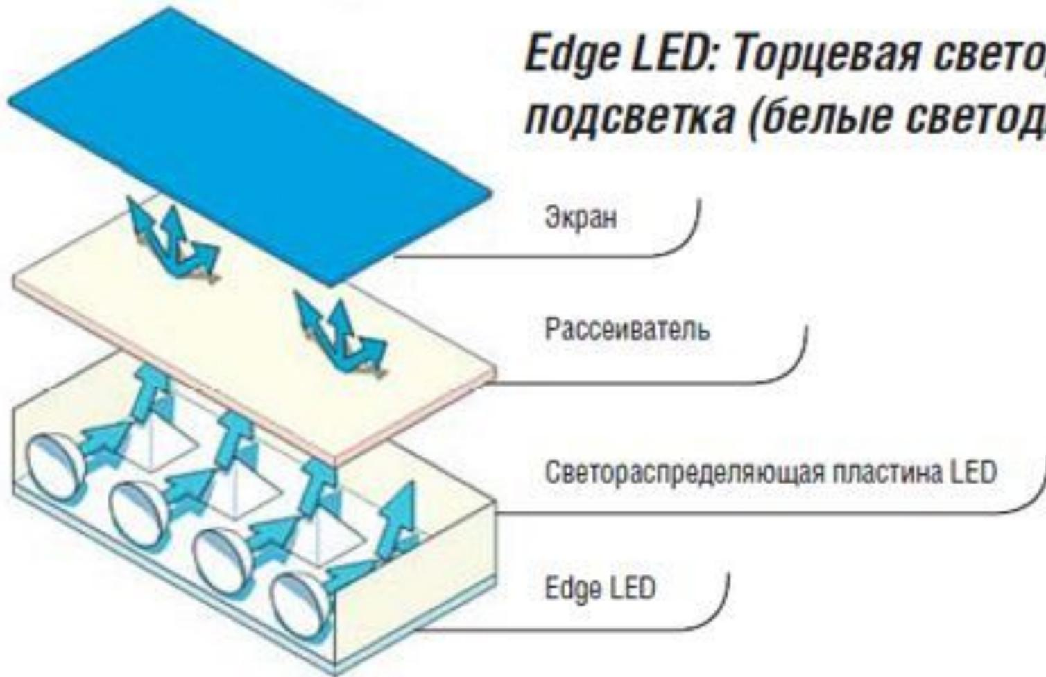
**Преимущество замены люминесцентных ламп на светодиоды – уменьшение общей толщины ЖК-панели.** В LED-телевизорах Samsung светодиоды размещены не за матрицей, а по её краям, благодаря чему наличие такого торцевого слоя практически не отражается на общей толщине, но значительно уменьшается вес.
