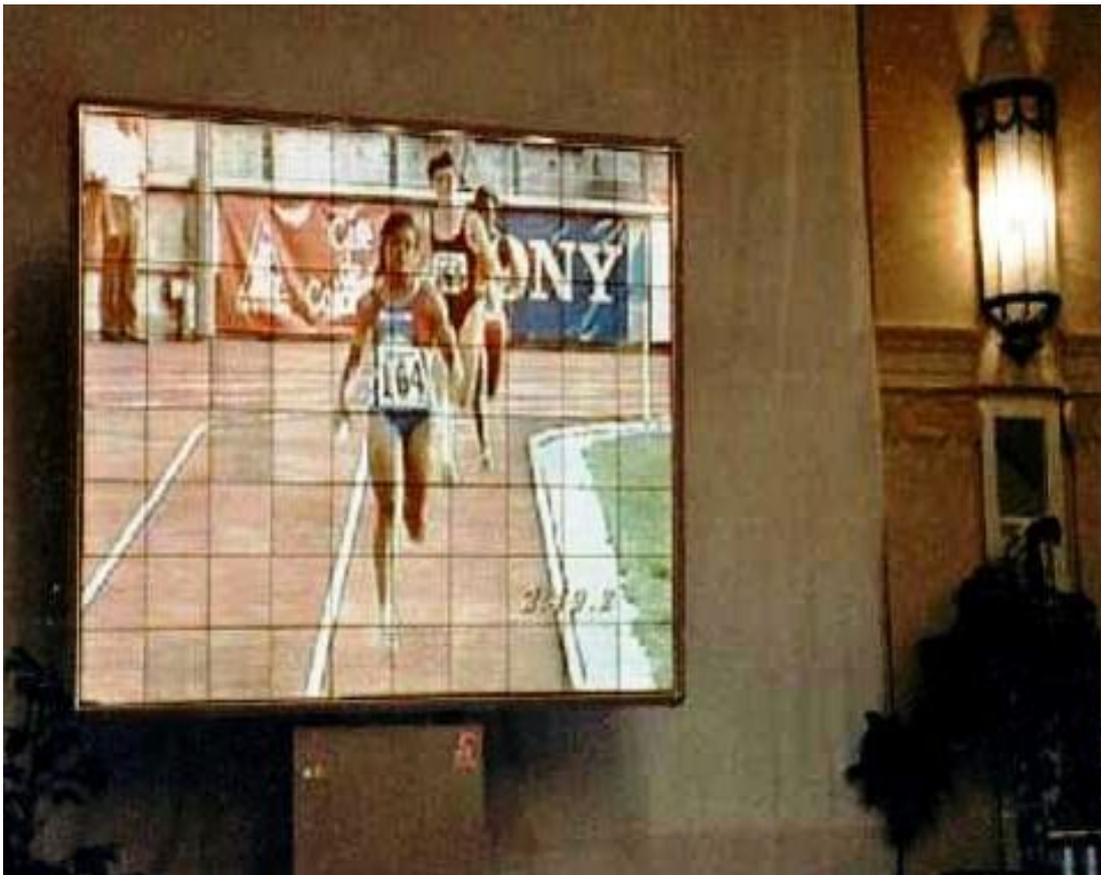
Чтобы изображение на модульном экране смотрелось слитно, панели для модульных экранов должны обеспечивать стыковку с min. потерей шага пикселей.
