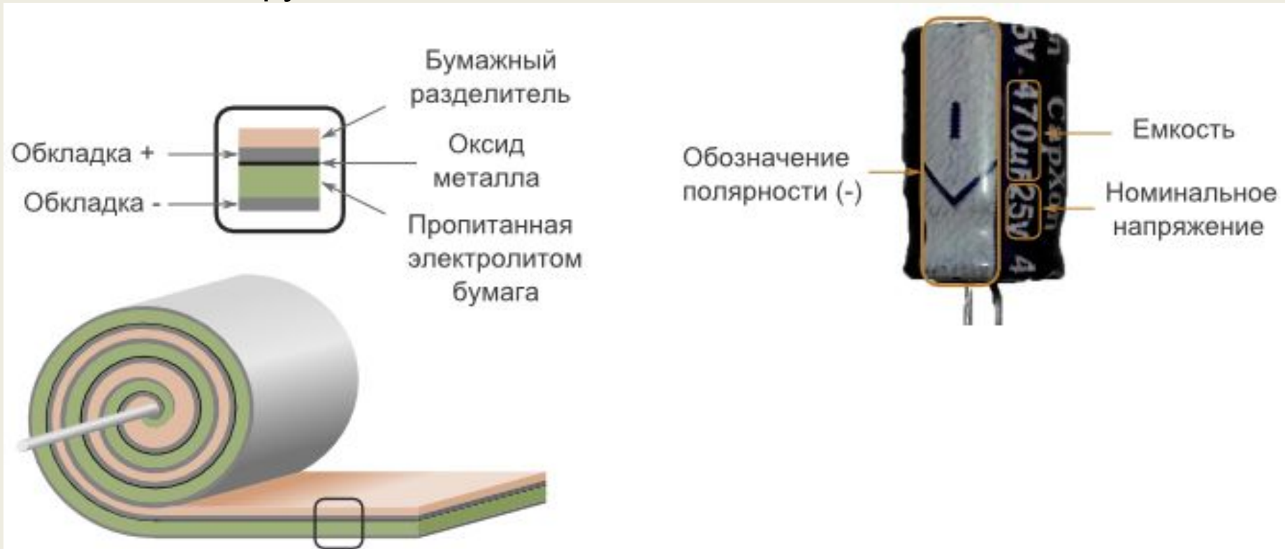
Рис. 12. Рулонная конструкция на примере электролитического конденсатора
