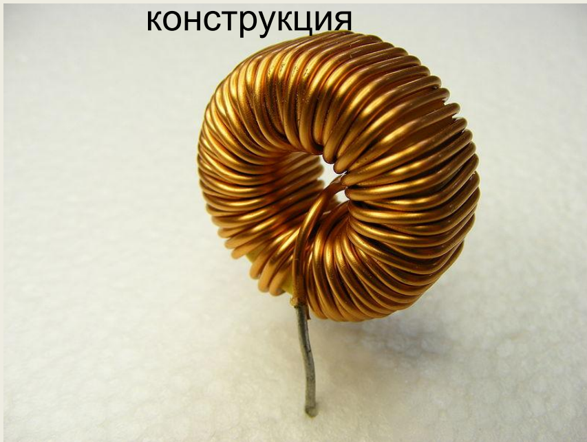
Рис. 16. Соленоидная конструкция индуктивности
