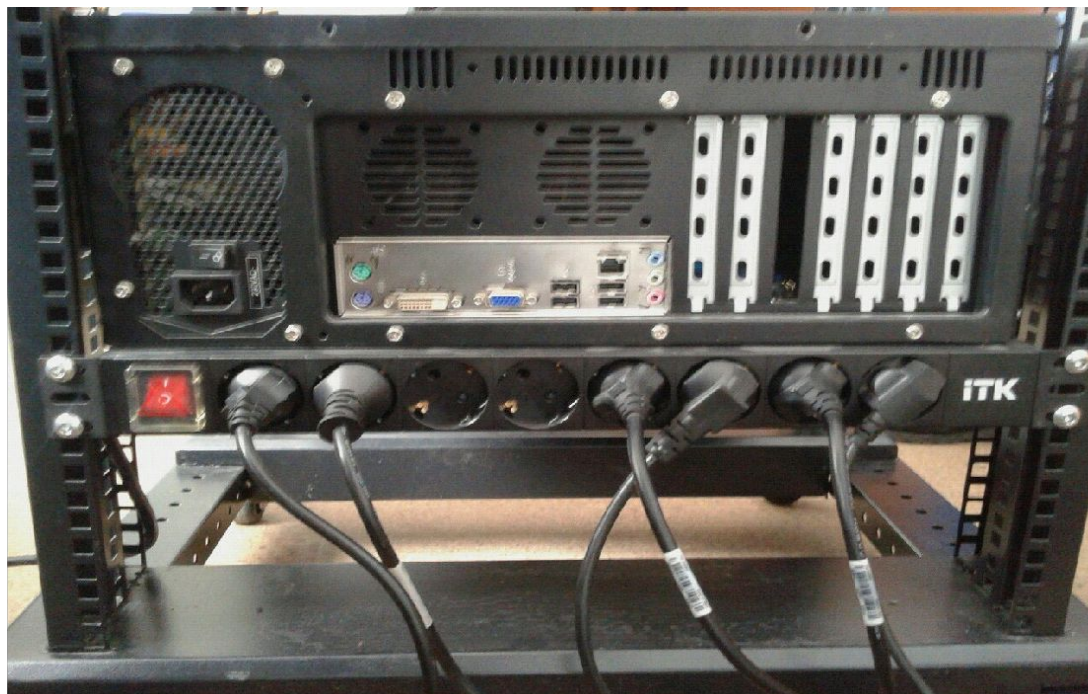
Рисунок 7. Сервер, установленный на сетевой фильтр
