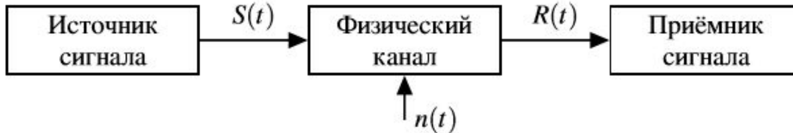
Рис.1. Структурная схема физического канала в общем виде
