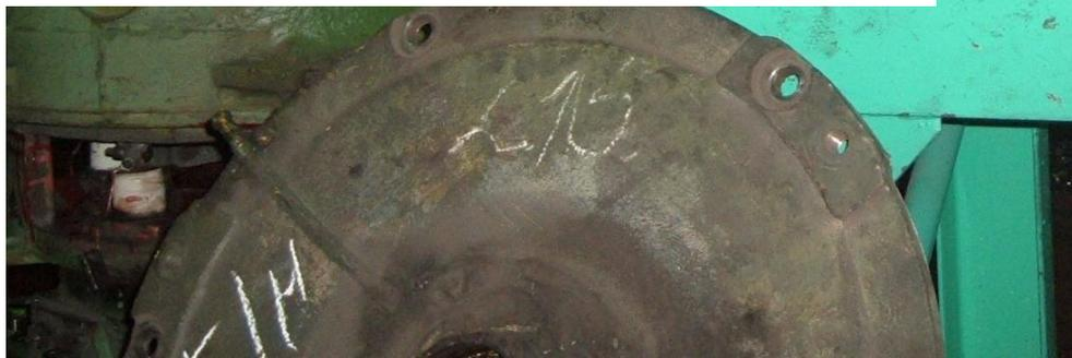
Подшипниковые щиты служат для размещения моторно-якорных подшипников, центровки вала якоря и создания запаса смазки
