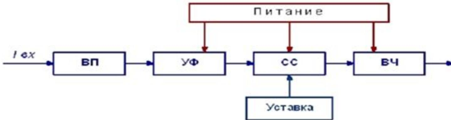
Структурная схема статического реле
