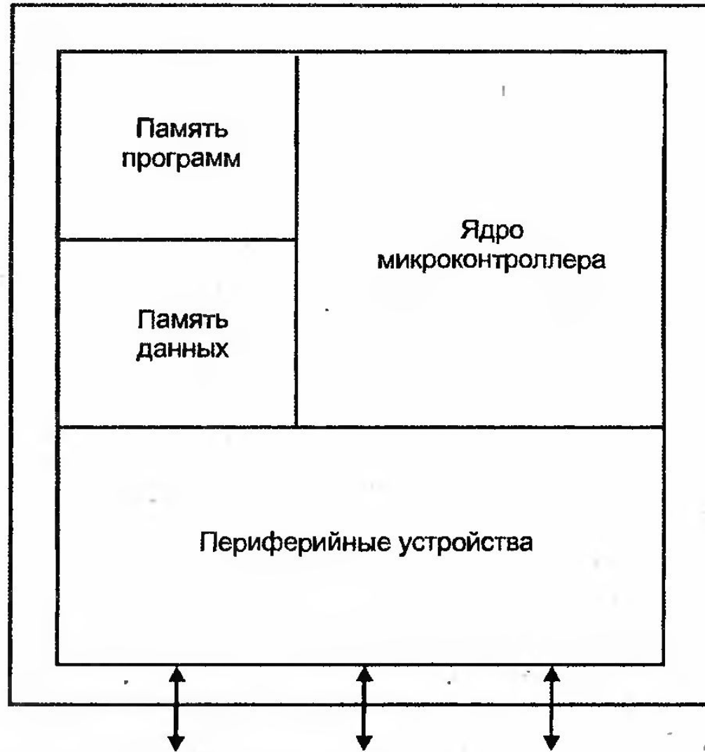
Рис. 1.1. Обобщенная структурная схема микроконтроллера
