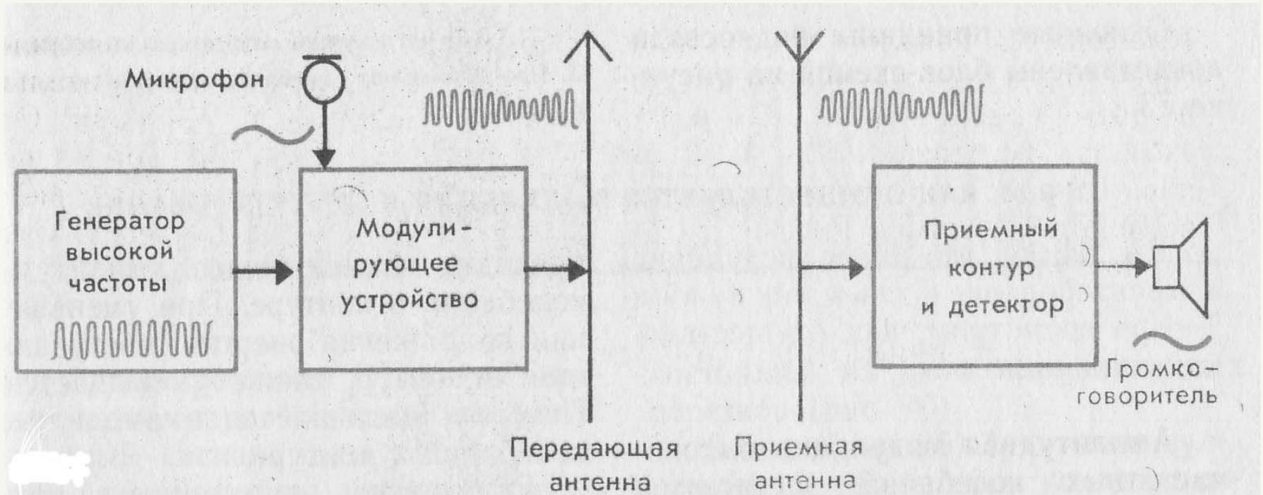
Для осуществления радиотелефонной связи необходимо использовать высокочастотные колебания. Для передачи звука эти высокочастотные колебания **модулируют** с помощью электрических колебаний низкой частоты. В приемнике же из модулированных колебаний высокой частоты выделяются низкочастотные колебания. Такой процесс преобразования сигнала называется **детектированием**.
