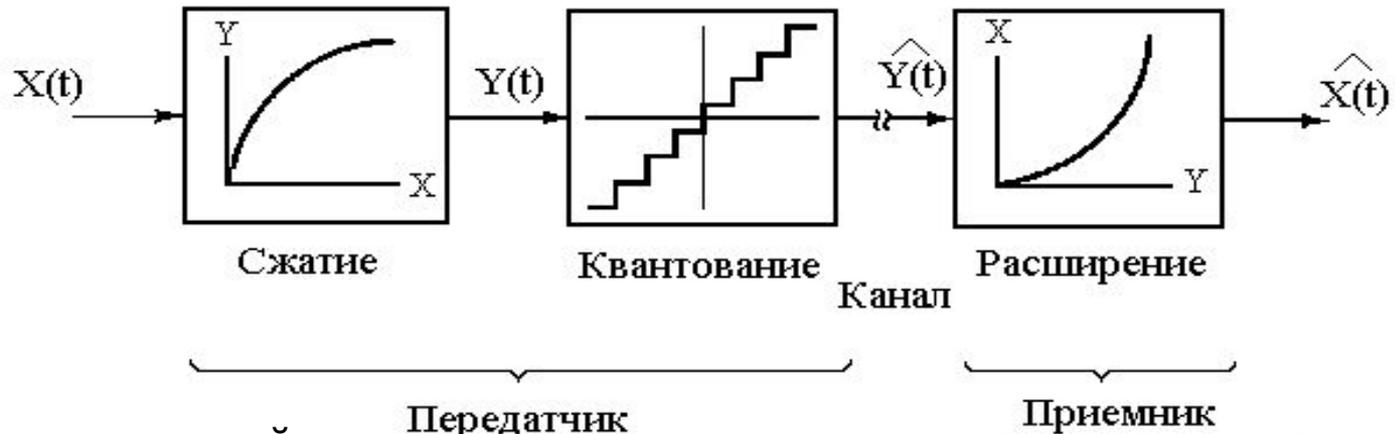
Неравномерный квантователь как совокупность компрессора, равномерного квантователя и экспандера
