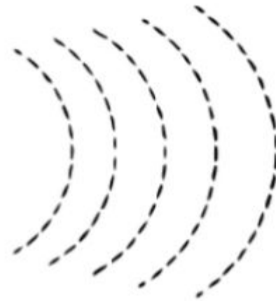
Рис.7. Сферический фронт ЭМ-волны в дальней зоне распространения
