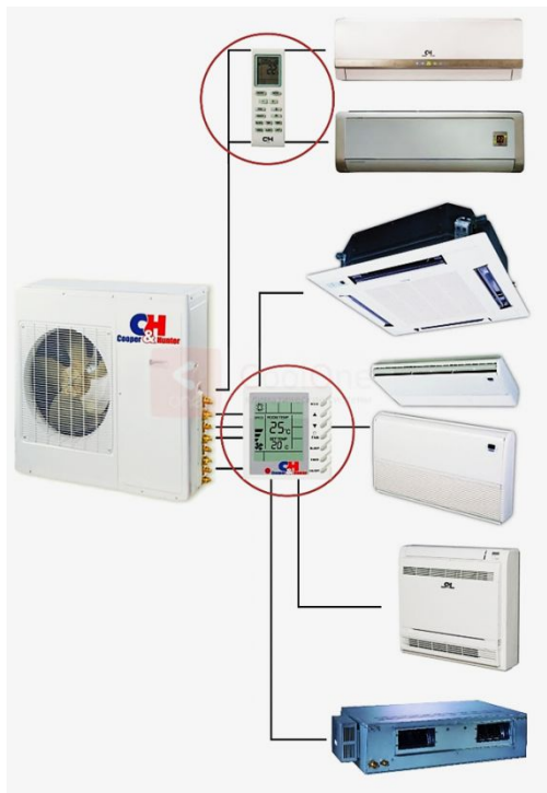
Зовнішній вид мульти - спліт системи
