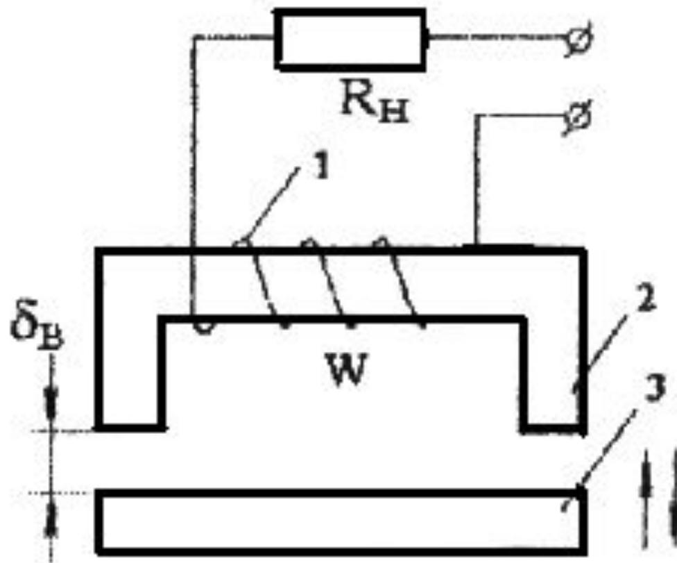
Рис.1 Схема индуктивного преобразователя
