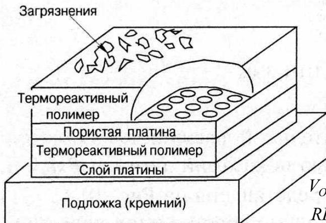
Конструкция емкостного датчика относительной влажности ННН-3610
