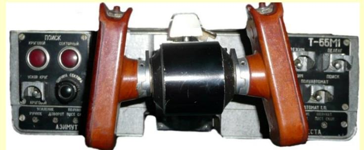
При крайних положениях рукояток управления замыкается концевой микровыключатель В10 блока управления антенной, включая схему полуавтоматического управления с постоянной скоростью.
