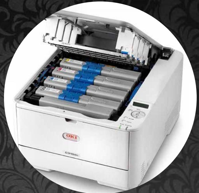
Светодиодная технология основывается на тех же базовых принципах, что и лазерная. Разница в том, что вместо лазерного луча на фотобарабан воздействует расположенная по всей его ширине неподвижная светодиодная линейка. Такая конструкция, во-первых, более компактна, во-вторых, менее подвержена поломкам и, в-третьих, снижает уровень шума.
