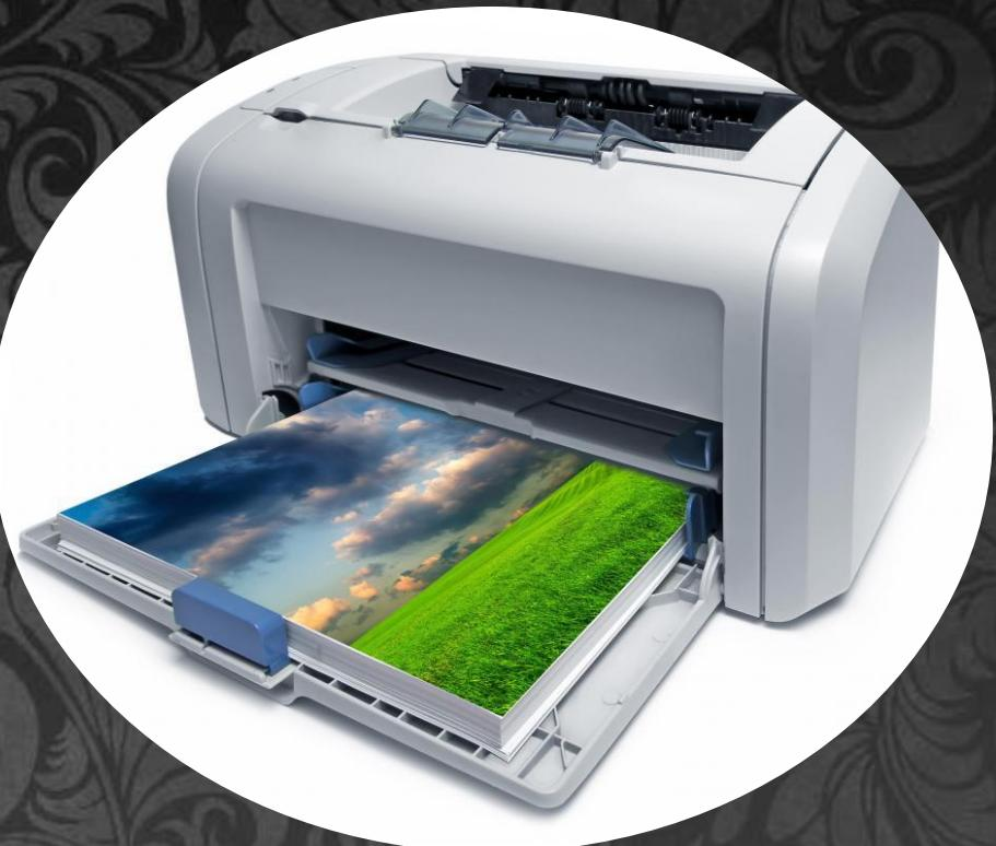
Данный тип принтеров имеет самое высокое качество печати, из-за чего и стоимость его самая большая среди всех печатных устройств. Такой принтер работает по принципу, похожему на тот, которым обладает фотокопировальный аппарат (ксерокс). Есть только одно отличие – изображение формируется при помощи лазера. Фотографии и документы, напечатанные лазерным принтером, могут похвастаться высоким качеством и устойчивостью к влаге и выцветанию.
