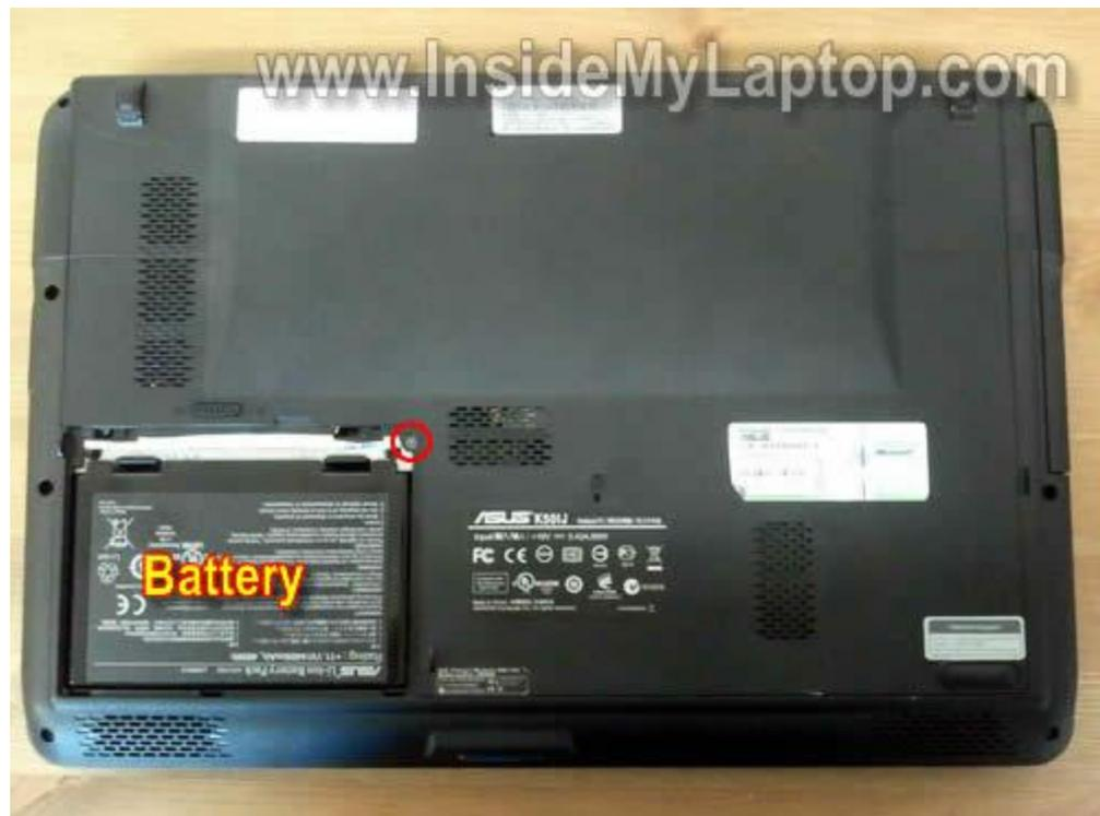
Выкрутите четыре винта, расположенных на нижней панели ноутбука и крепящих нижнюю крышку.
