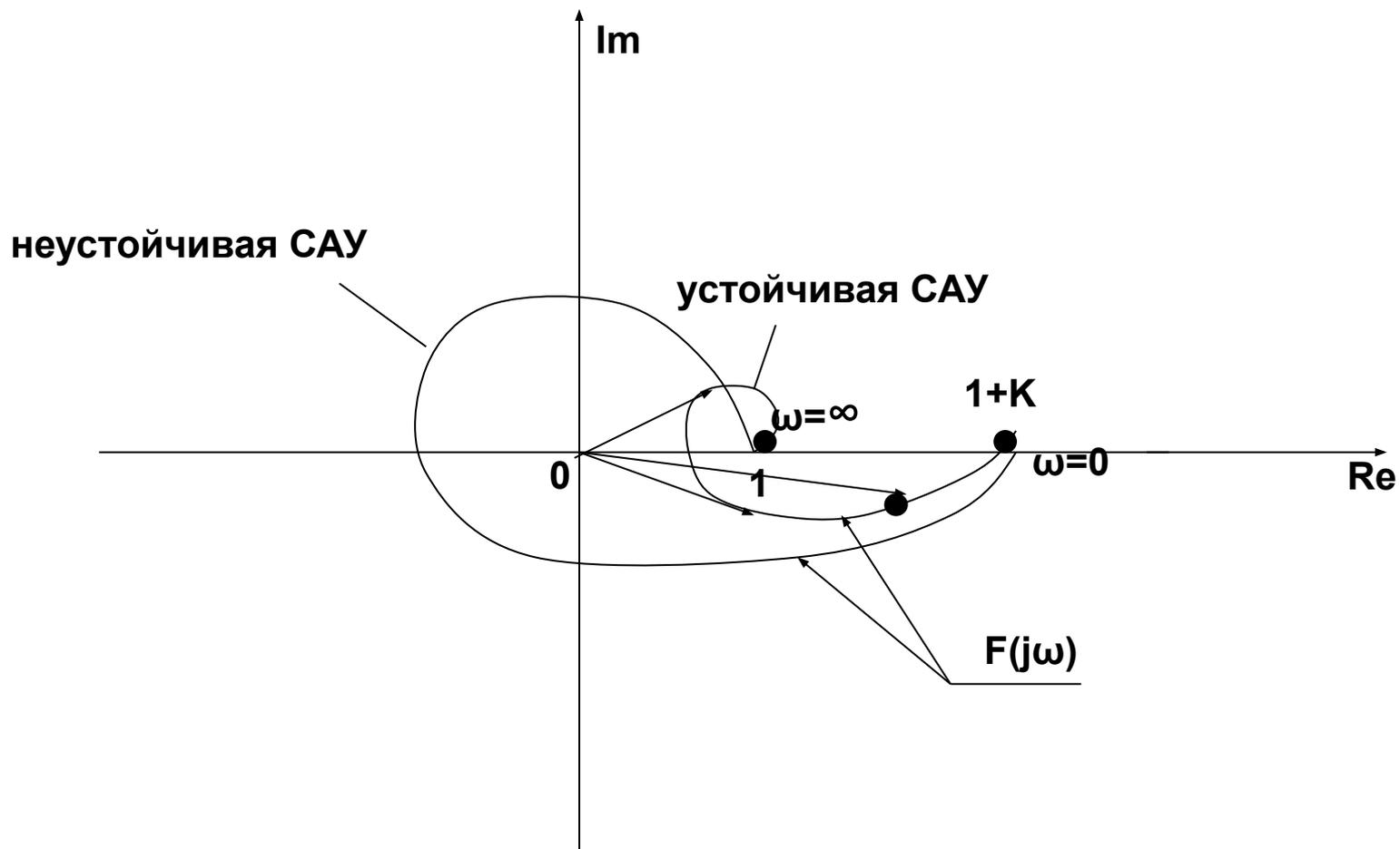
Сдвинем теперь  $F(j\omega)$  влево на "1" и получим, таким образом,  $w_p(j\omega)$
