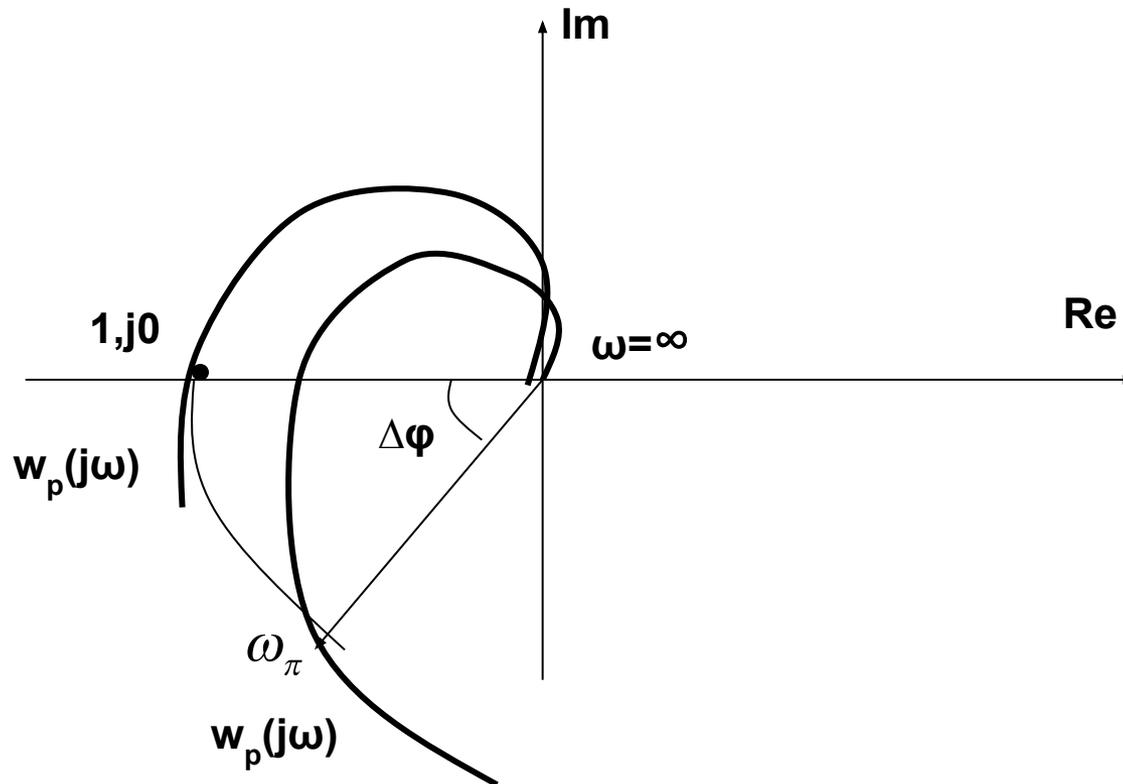
Проводя окружность радиусом “1” можно найти ту точку  $\omega_{\pi}$ , которая попадет в точку  $(-1; j0)$  если на частоте  $\omega_{\pi}$   $\varphi(\omega_{\pi})$  увеличится на угол  $\Delta\varphi$ .
