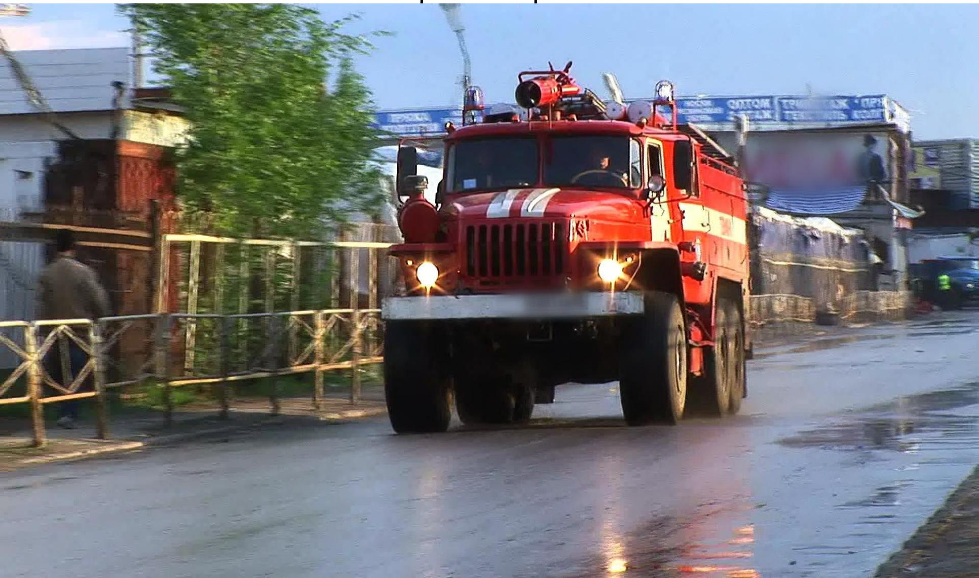
На автомобилях специального назначения (санитарные, пожарные, милицейские) дополнительно устанавливаются проблесковые маяки (желтые, красные, синие), а также подвижные поисковые прожекторы.
