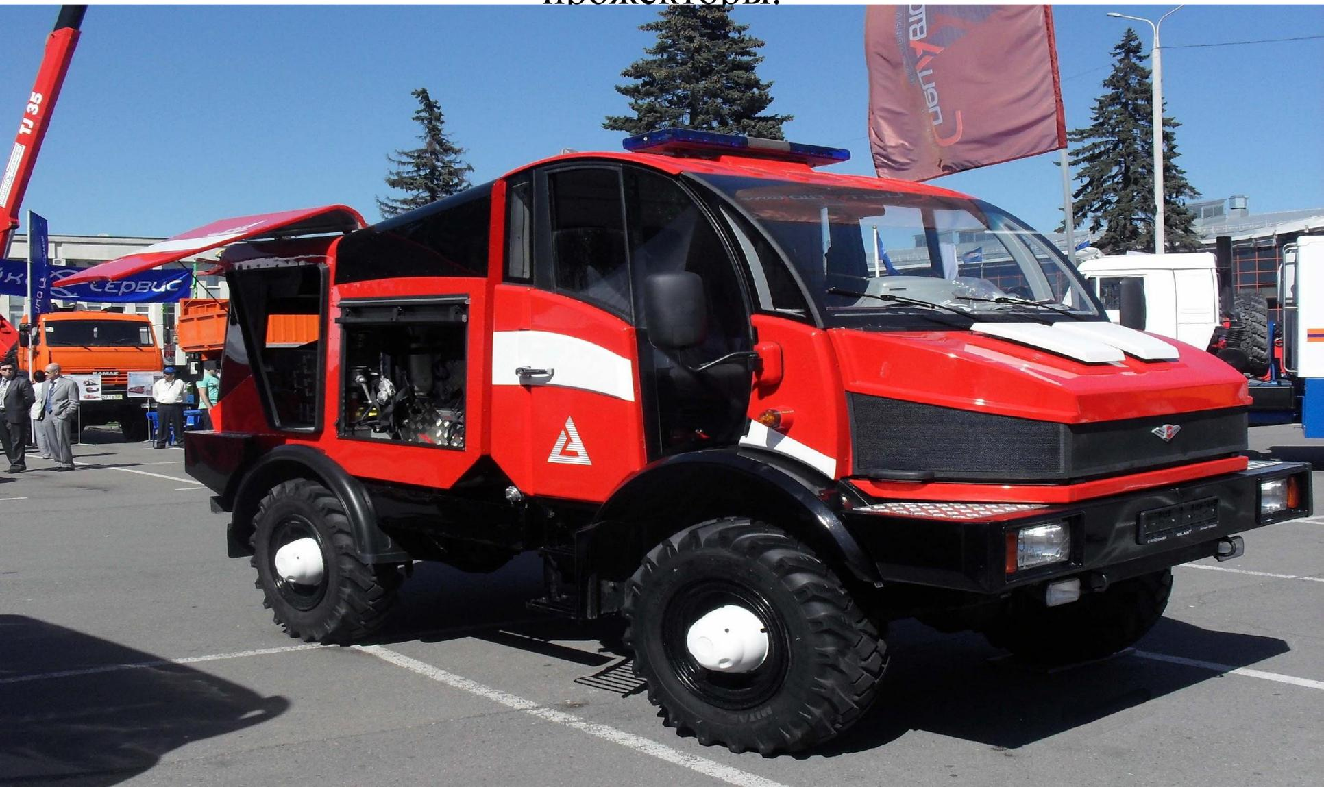
На автомобилях специального назначения (санитарные, пожарные, милицейские) дополнительно устанавливаются проблесковые маяки (желтые, красные, синие), а также подвижные поисковые прожекторы.
