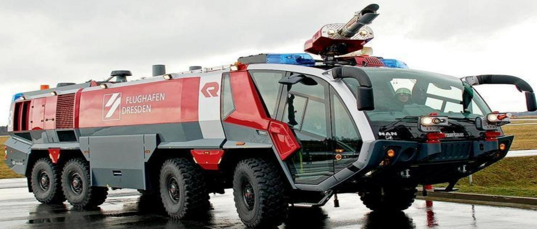
На автомобилях специального назначения (санитарные, пожарные, милицейские) дополнительно устанавливаются проблесковые маяки (желтые, красные, синие), а также подвижные поисковые прожекторы.
