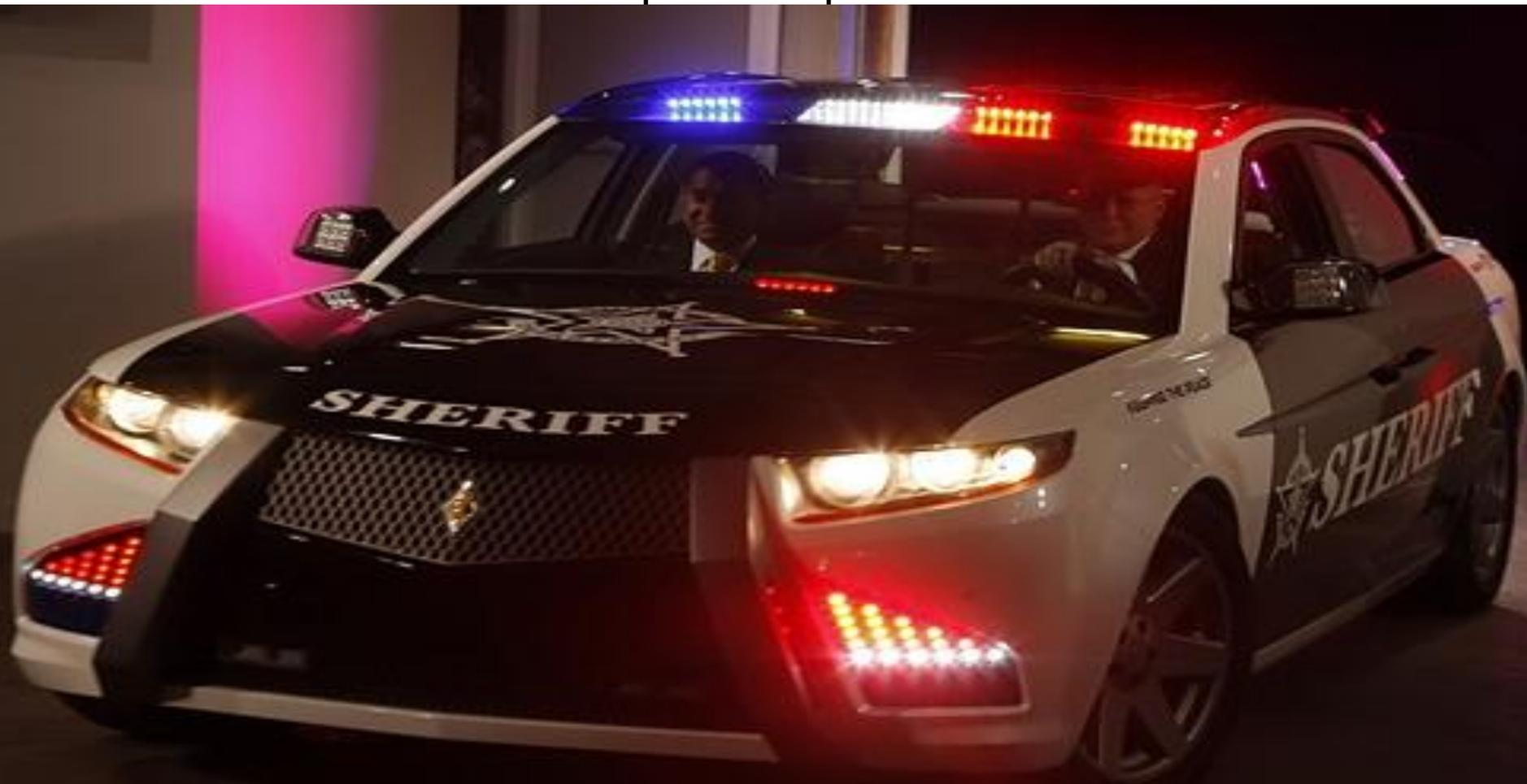
На автомобилях специального назначения (санитарные, пожарные, милицейские) дополнительно устанавливаются проблесковые маяки (желтые, красные, синие), а также подвижные поисковые прожекторы.
