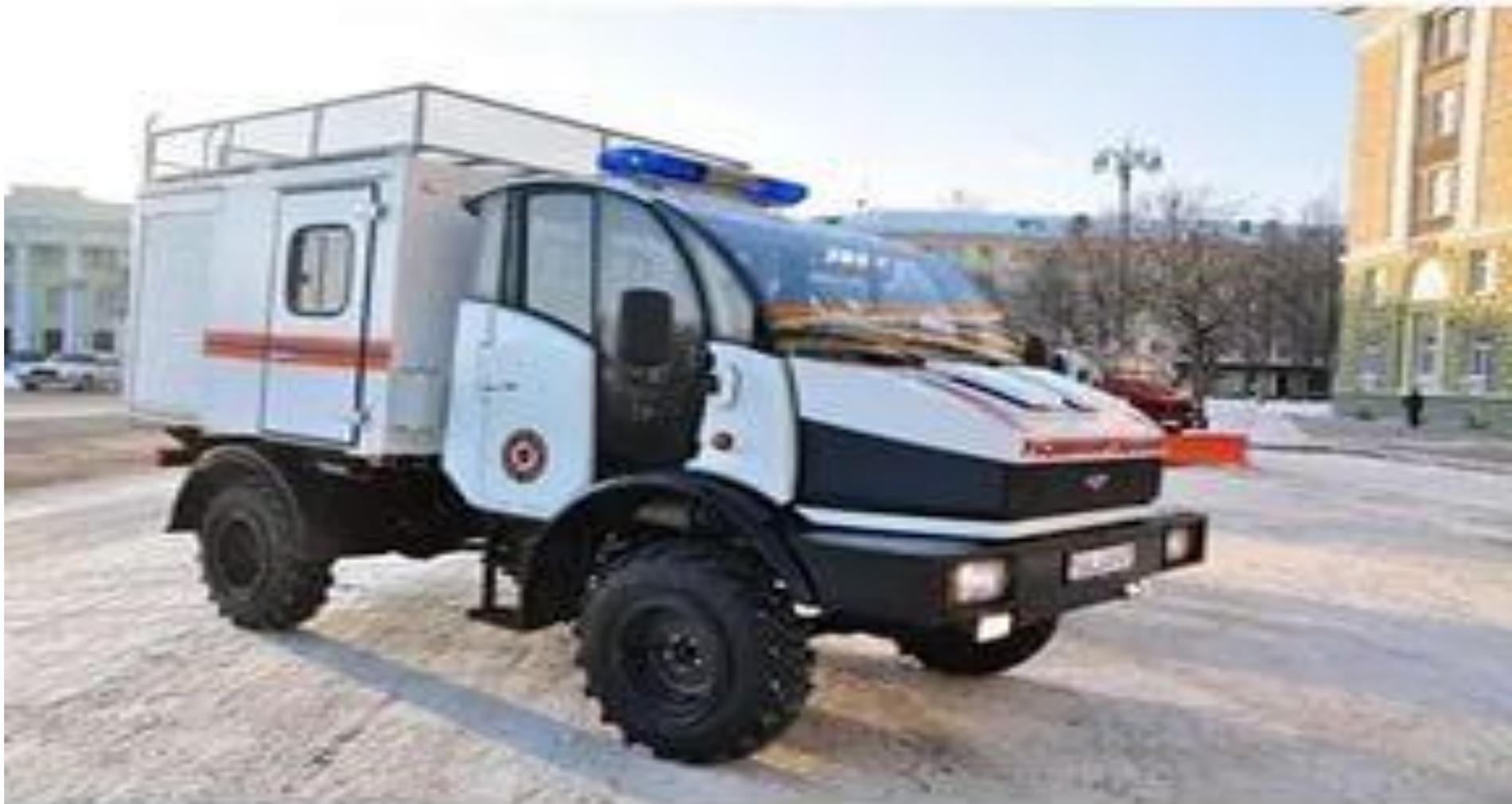
На автомобилях специального назначения (санитарные, пожарные, милицейские) дополнительно устанавливают проблесковые маяки (желтые, красные, синие), а также подвижные поисковые прожекторы.
