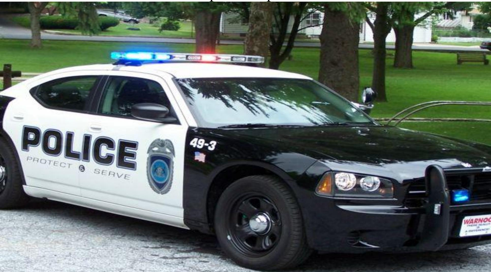
На автомобилях специального назначения (санитарные, пожарные, милицейские) дополнительно устанавливают проблесковые маяки (желтые, красные, синие), а также подвижные поисковые прожекторы.
