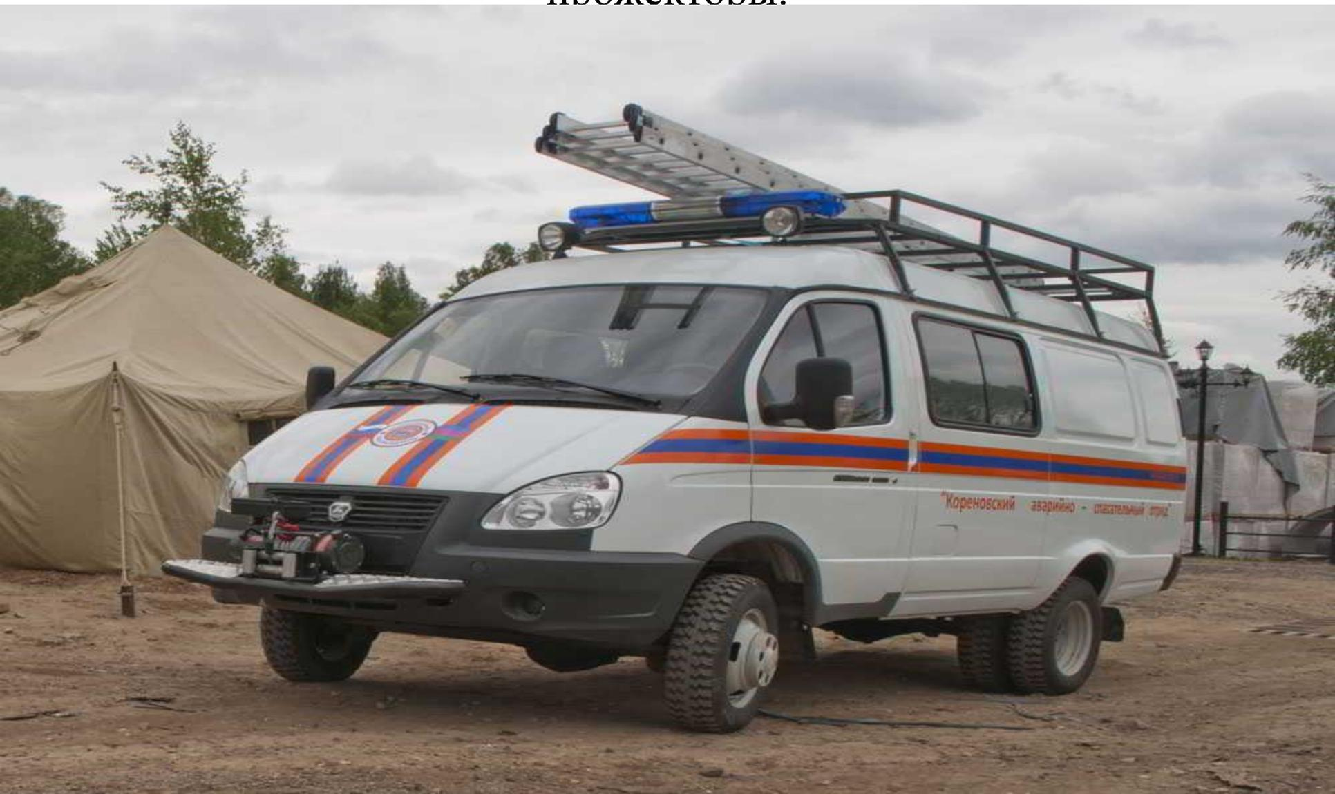
На автомобилях специального назначения (санитарные, пожарные, милицейские) дополнительно устанавливают проблесковые маяки (желтые, красные, синие), а также подвижные поисковые прожекторы.
