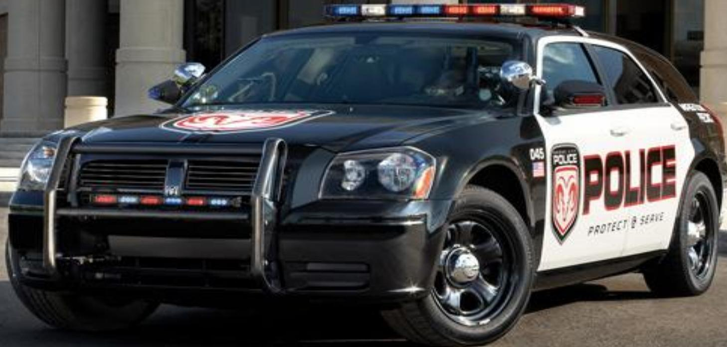
На автомобилях специального назначения (санитарные, пожарные, милицейские) дополнительно устанавливают проблесковые маяки (желтые, красные, синие), а также подвижные поисковые прожекторы.
