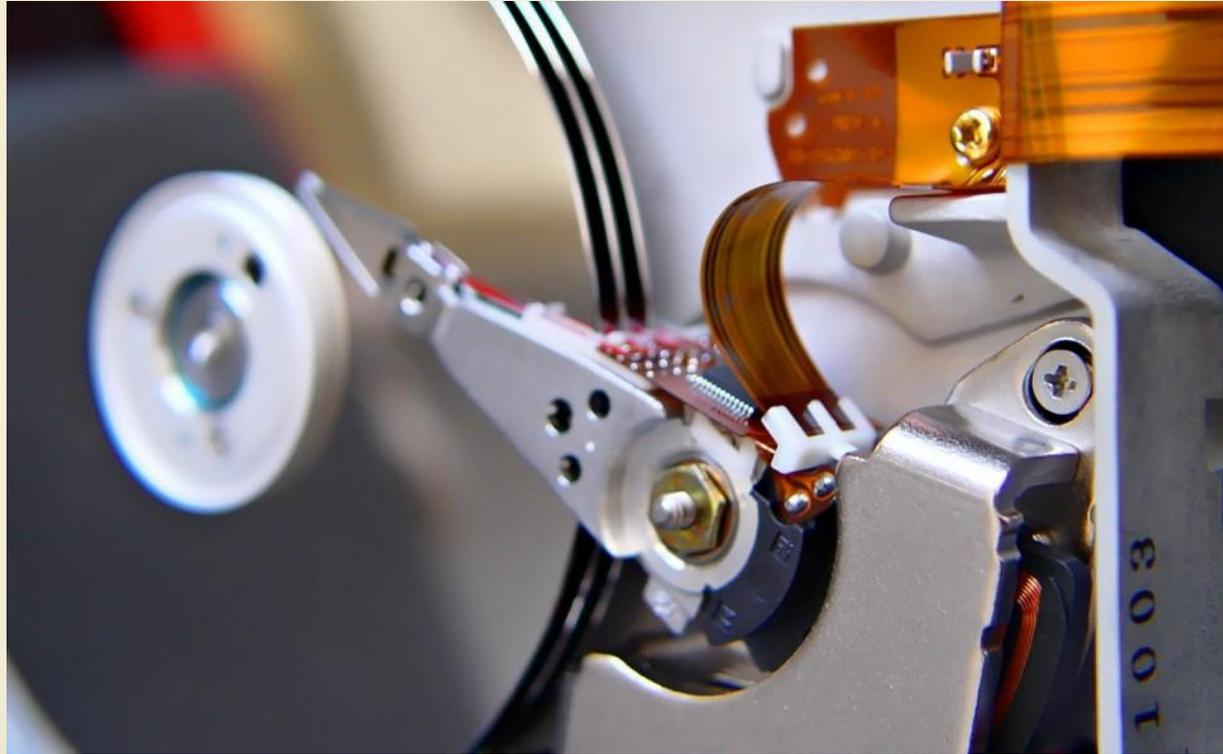
Основные принципы работы жесткого диска мало изменились со дня его создания. Устройство винчестера очень похоже на обыкновенный проигрыватель грампластинок.
