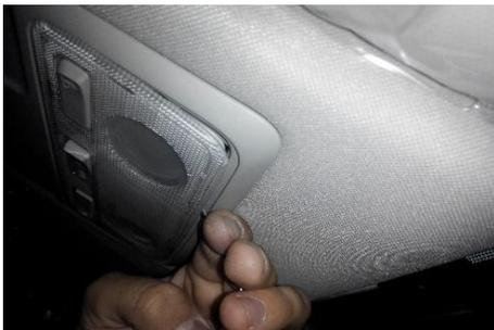
Аккуратно поддеваем прозрачную крышку как показано на рисунках, прилагая небольшое усилие и снимаем ее.
