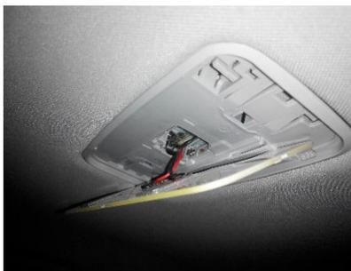
Устанавливаем новую светодиодную плату. Перед тем как фиксировать плату, проверьте ее работоспособность. Соблюдайте полярность.
