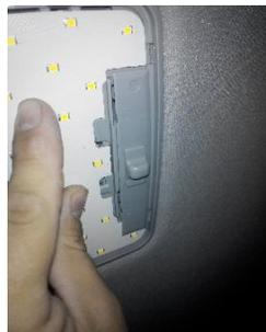
При помощи двухстороннего скотча, расположенного по краям, фиксируем плату на месте.
