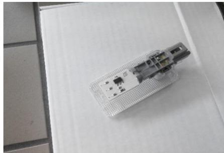
Устанавливаем новую светодиодную плату. Соблюдаем полярность.
