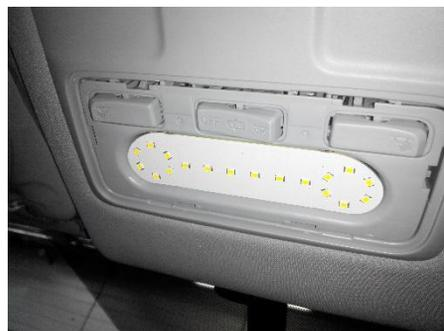
Устанавливаем новую светодиодную плату.
