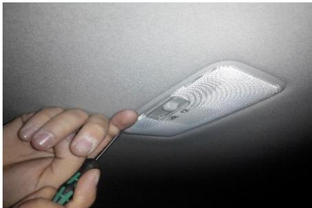
Аккуратно поддеваем прозрачную крышку и снимаем ее.
