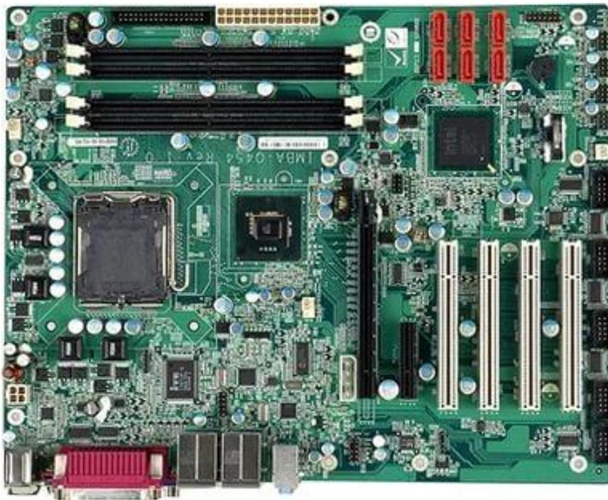
Материнская плата –это основная плата в компьютере. На неё крепятся оперативная память, видеокарта, процессор, кулер. На ней также находятся микросхема с BIOS и батарейка для его работы.
