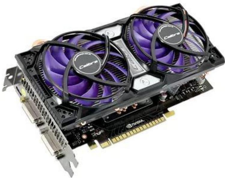
Видеокарта – устройство, преобразующее графический образ, хранящийся как содержимое памяти компьютера или самого адаптера, в иную форму, предназначенную для дальнейшего вывода на экран монитора. В настоящее время эта функция утратила своё основное значение и в первую очередь под графическим адаптером понимают устройство с графическим процессором – графический ускоритель, который и занимается формированием самого графического образа.
