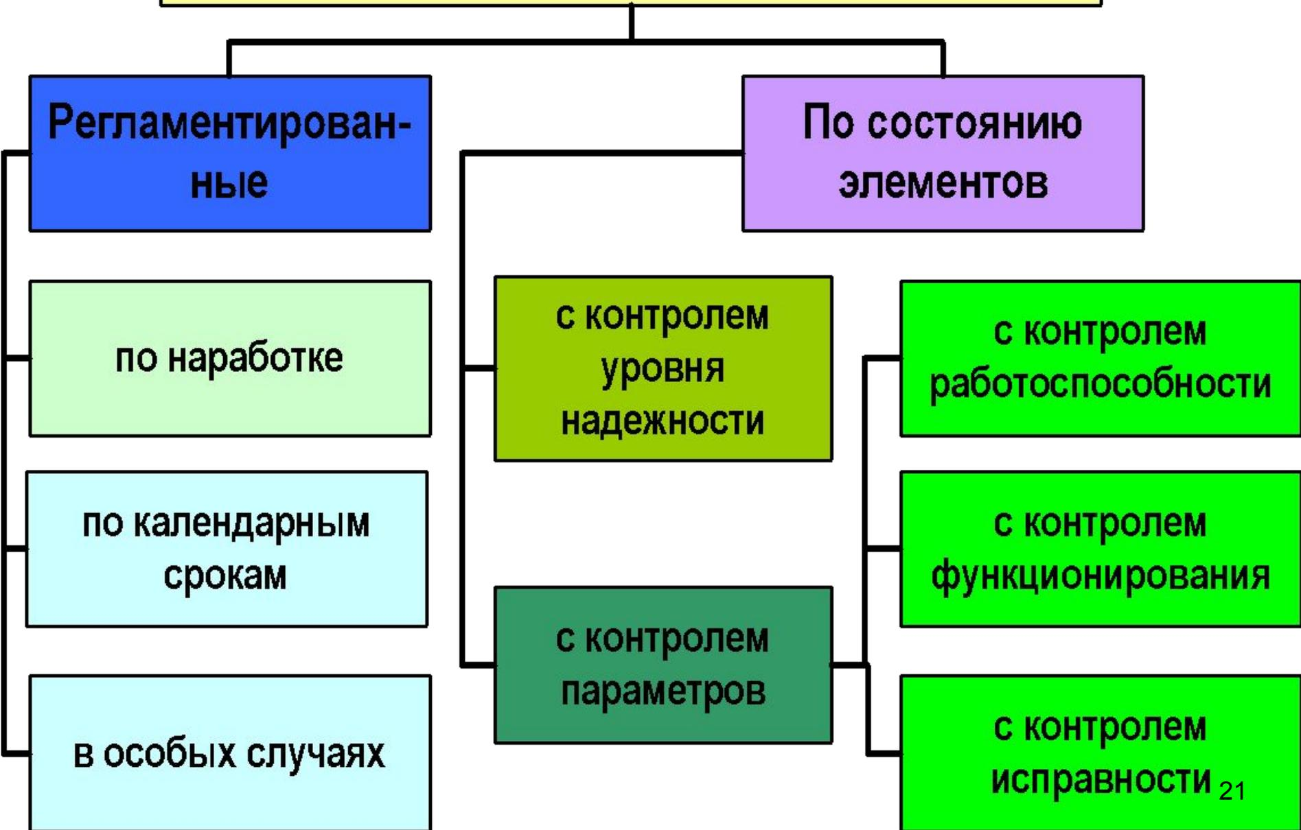
**Подсистема технического обслуживания РТС и КСН** предназначена для обеспечения их надёжной и эффективной работы.
