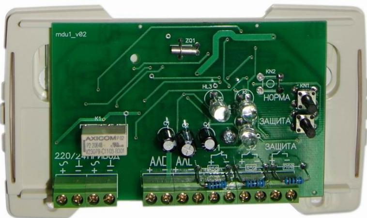
Адресный модуль дымоудаления МДУ-1 предназначен для управления 3 типами приводов клапанов дымоудаления или огнезащиты:
