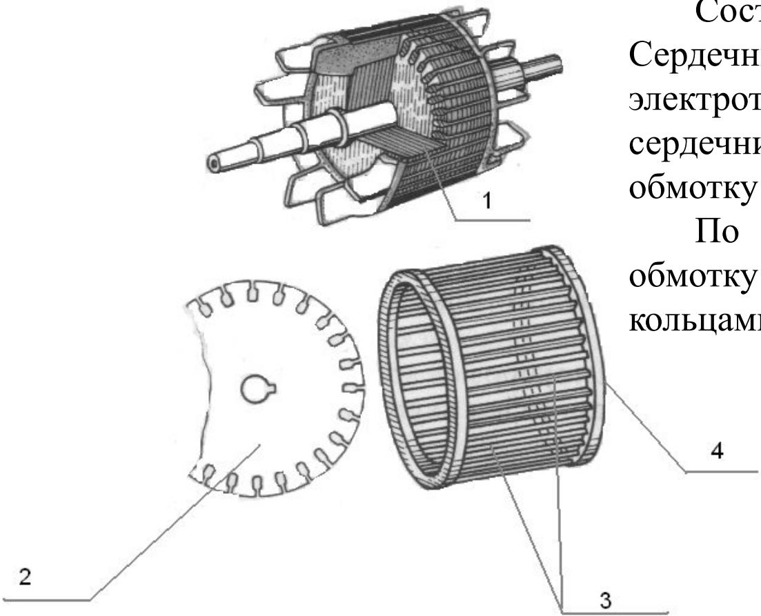
Состоит из сердечника (1). Сердечник набран из листов электротехнической стали (2), в пазы сердечника укладывают стержневую обмотку (3).
