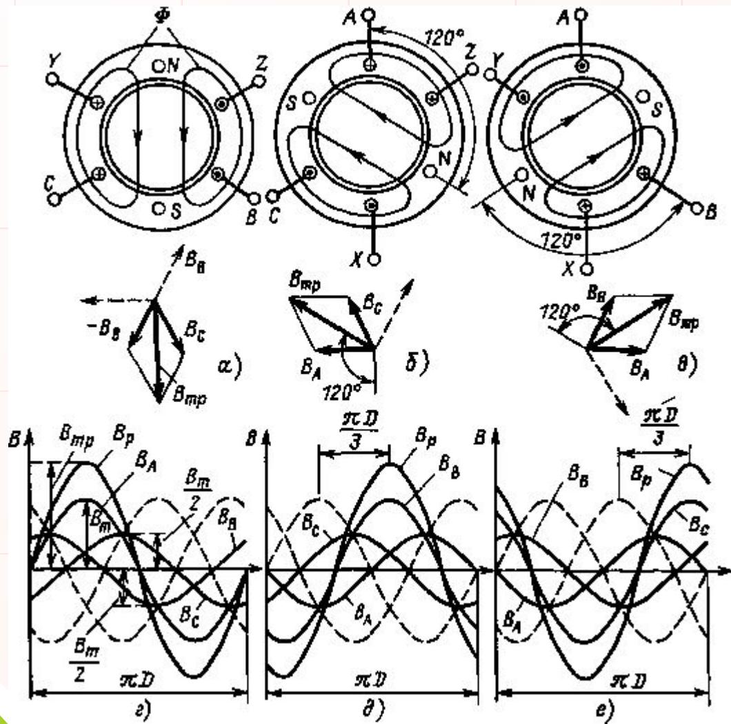
Обмотка статора состоит из 3-х групп катушек смещенных по окружности статора на угол 120° и подключается к 3-х фазной системе ЭДС, где ток каждой фазы смещен во времени на 1/3 периода (120°).
