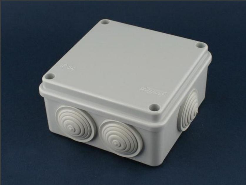
**Распределительная коробка** - представляет собой пластиковую коробку с крышкой, по торцам которой имеются отверстия для ввода провода. По типу, распределительные коробки выполняются для открытой и скрытой проводки.
