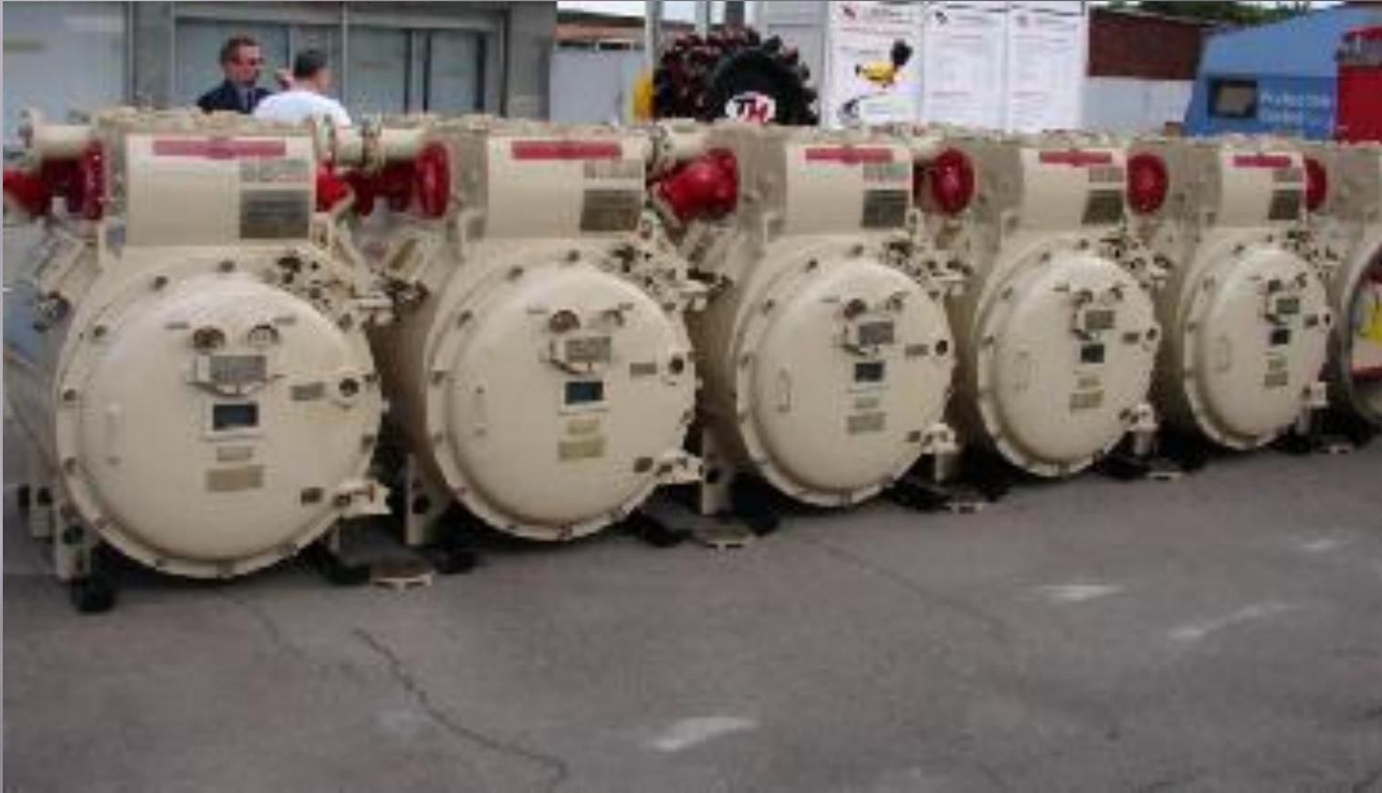
КРУ предназначено для приема и распределения электрической энергии напряжением 6 кВ частотой 50 Гц, для защиты сетей с изолированной нейтралью и управления подземными токоприемниками угольных шахт, опасных по газу и пыли.
