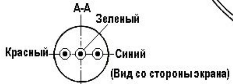
Конструктивно кинескоп представляет собой стеклянную колбу с **люминофорным мозаичным экраном- 3**, внутри которого расположены 3 электронные пушки для красного, синего и зеленого цвета (RGB), которые, в отличие от дельта кинескопа, расположены в одной горизонтальной плоскости, причем зеленый совпадает с осью кинескопа, а остальные два повернуты относительно оси на  $1,50$ .
