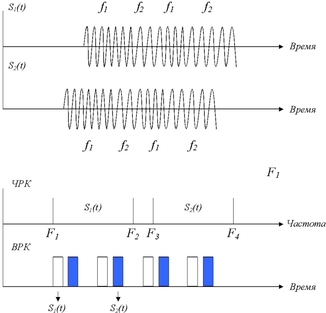
Частотное и временное разделение каналов для уплотнения среды передачи сигналов.
