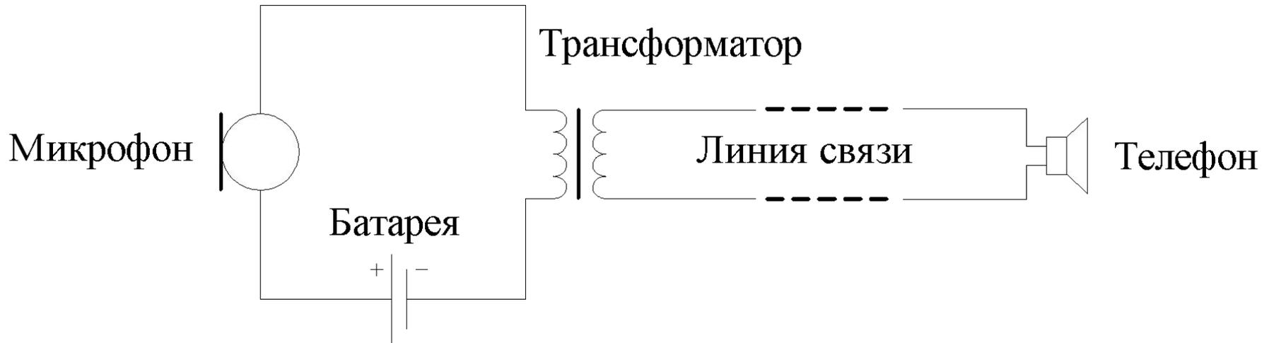
Схема передачи телефонного сигнала с использованием местной батареи
